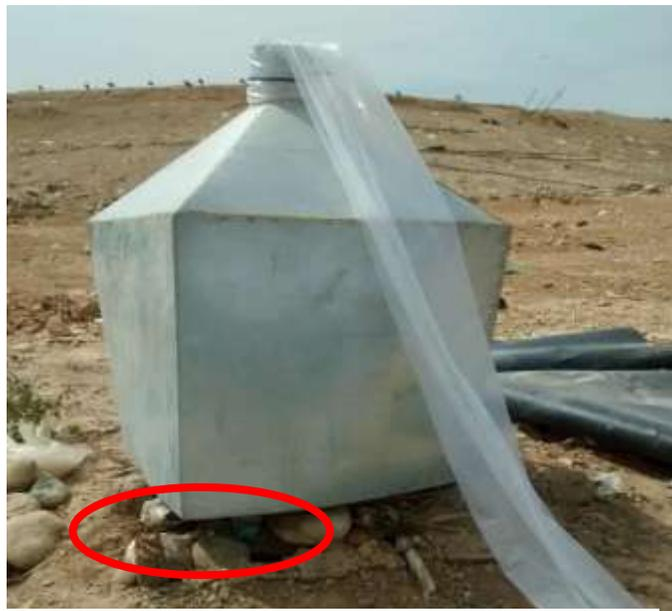
*Figura 4.8.* Campana para captura de muestra de Biogás.
