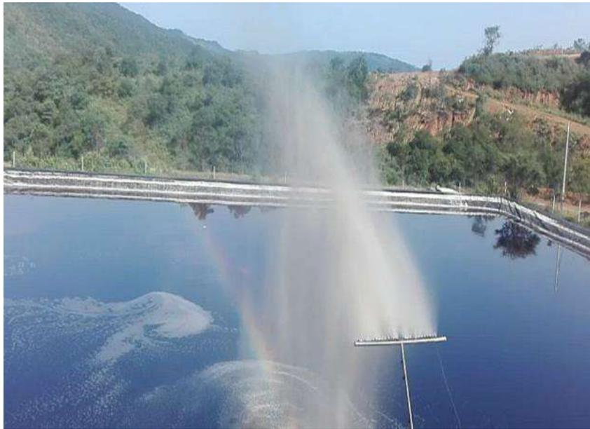
*Figura 4.3.* LandShark para evaporación de lixiviados.
