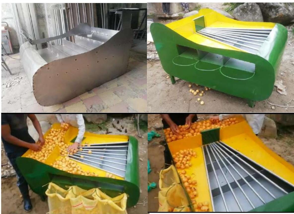
Figura 79 Autor (2020) Construcción de modelo de comprobación
