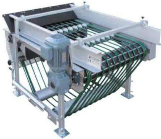
Figura 27 Fordertechnik (2018) Seleccionadora de Patatas Recuperado de:
