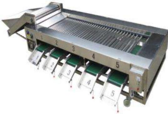
Figura 20 Hong Xin (2014) Máquina clasificadora de patatas Recuperado de:
