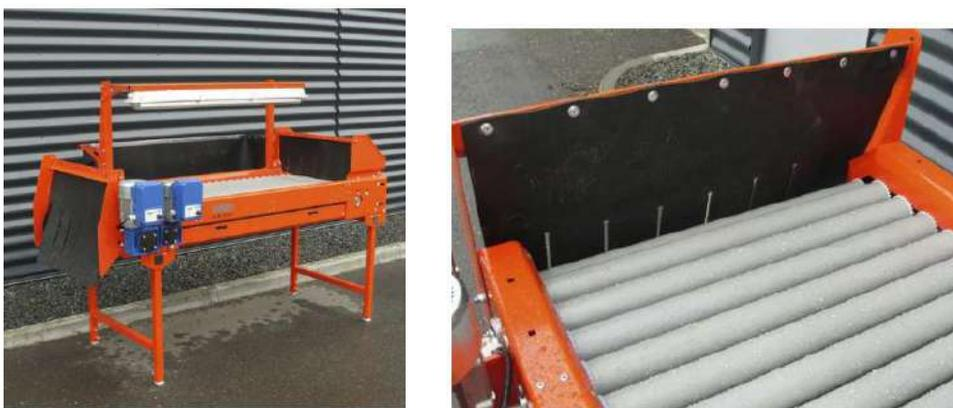
Figura 25 Ekko (2018) Mesa de separación de papatas EM 171. Recuperado de:
