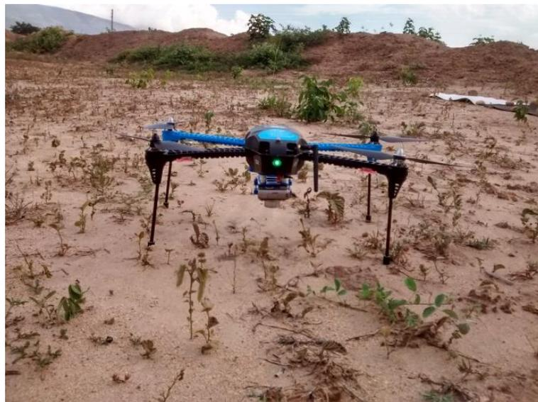
Figura 28. IRIS+ con la cámara instalada. Fuente: Autor.
