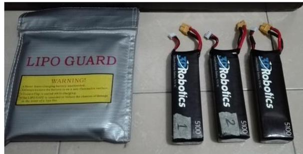
Figura 27. Baterías para el dron Iris+ 3DR. Fuente: Autor.
