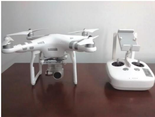
Figura 6. Dron de ala rotatoria. Fuente: (Autor)
