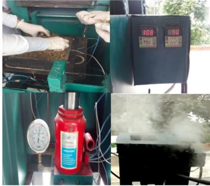
**Figura 46.** Prensado de la mezcla en el equipo aglomerador
