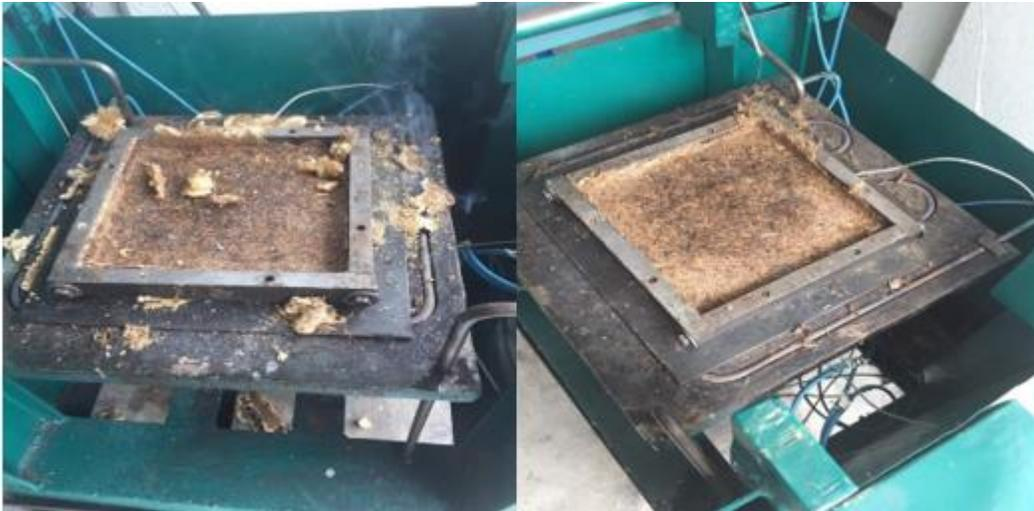
**Figura 47.** Proceso de curado de los tableros
