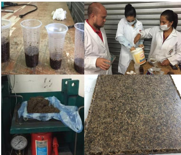
**Figura 41.** Pruebas preliminares con la fibra de palma y resina poliéster insaturada
