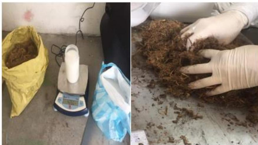
**Figura 44.** Proceso de mezclado de la fibra con la resina
