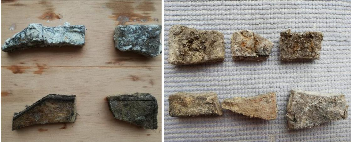
*Fuente: Propia. La imagen de la izquierda fue tomada al iniciar la prueba, en esta, los residuos de la parte superior corresponden a los que fueron dejados en intemperie y los de la parte inferior corresponden a los que estaban bajo techo. La imagen de la derecha fue tomada un mes y medio después, los residuos de la parte superior corresponden a los que fueron dejados en intemperie y los de la parte inferior corresponden a los que estaban bajo techo.*
