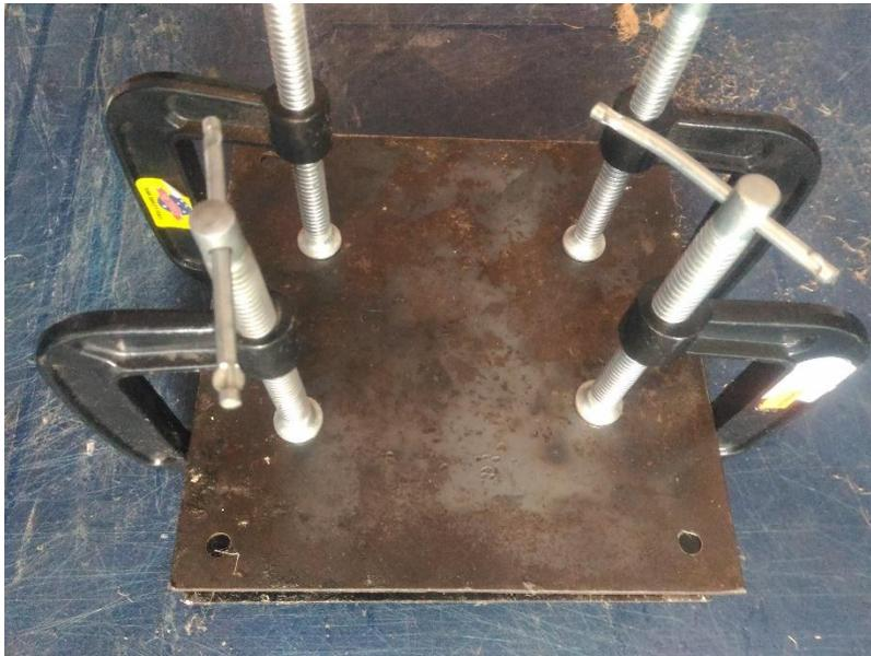
*Fuente: Propia. Se prensa los moldes para poder compactar la pasta, tomando la forma de los moldes y evitando que se deforme durante su secado.*
