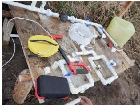
**Figura 7.14:** Instalación de sistema Venturi y electroválvulas.
