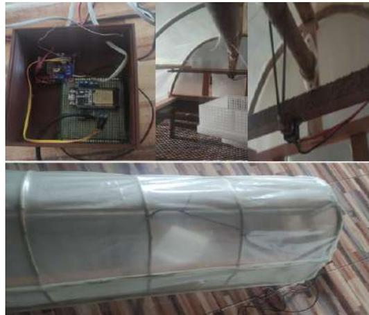
**Figura 6.24:** Instalación de sensores y actuador en prototipo final de secador de café a escala
