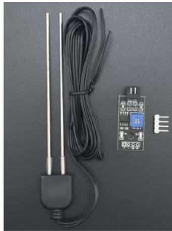
**Figura 8.4:** Sensor de humedad de suelo HD-38.
