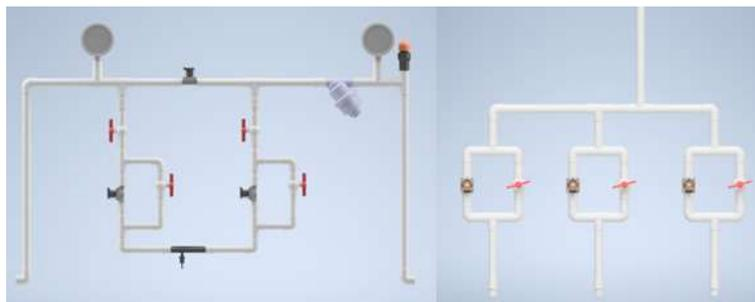
**Figura 7.7:** Diseño 3D de sistema Venturi y sistema de riego.
