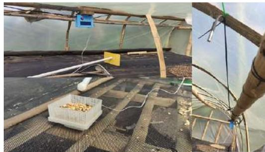
**Figura 6.45:** instalación final del sistema dentro del secador de café
