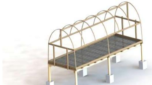
**Figura 6.27:** Diseño de estructura de secador real en Autodesk Inventor
