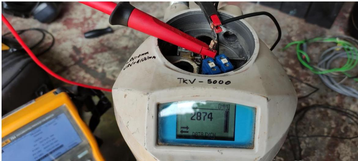
**Imagen 21.** Calibración de Transmisor Sitrans LR250(Siemens). Autor.
