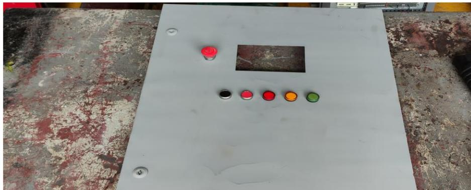
**Imagen 19.** Corte de lámina para pantalla y ubicación de pilotos-pulsadores. Autor.
