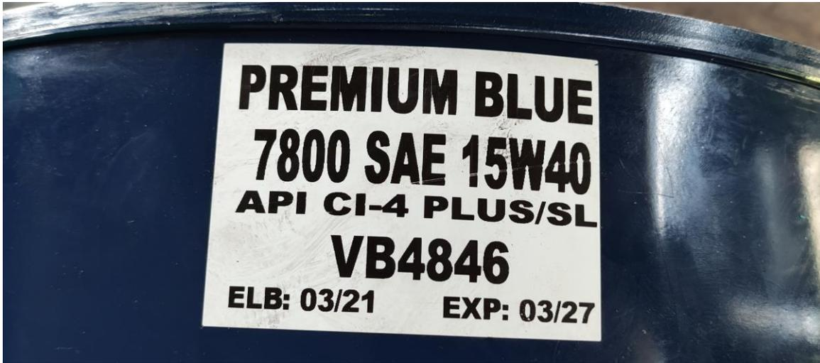
Imagen 11. Referencia de aceite para motores de combustión. Autor.
