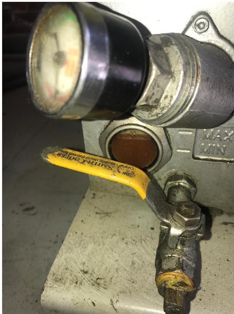
**figura 41** Nivel de aceite de bombas de vacío
