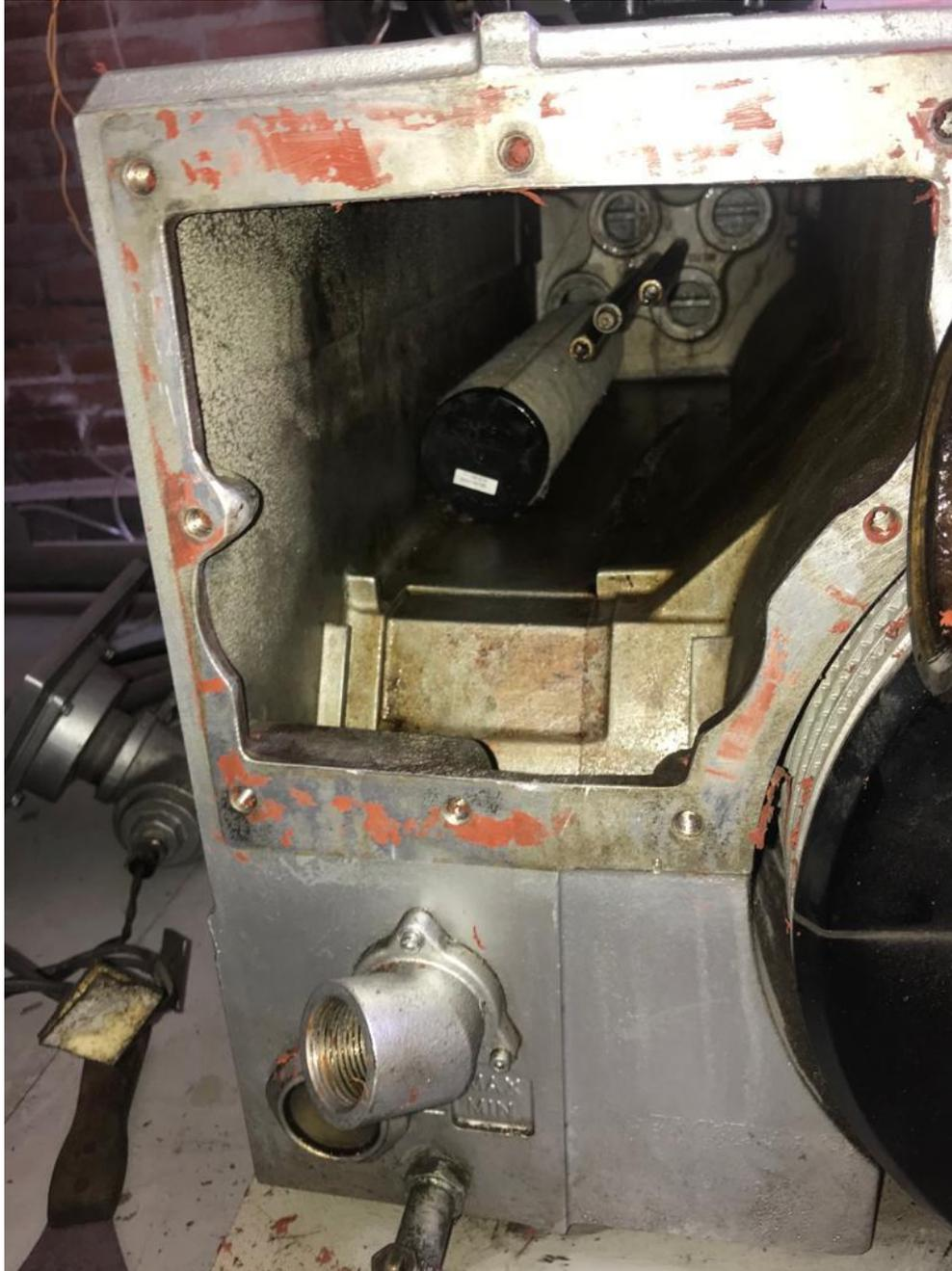
**figura 43** Limpieza de cavidad interior de bomba de vacío
