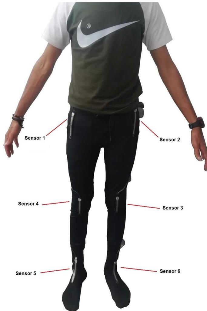
**Figura 3.25:** Vista frontal del traje con los sensores Flex [Autor].
