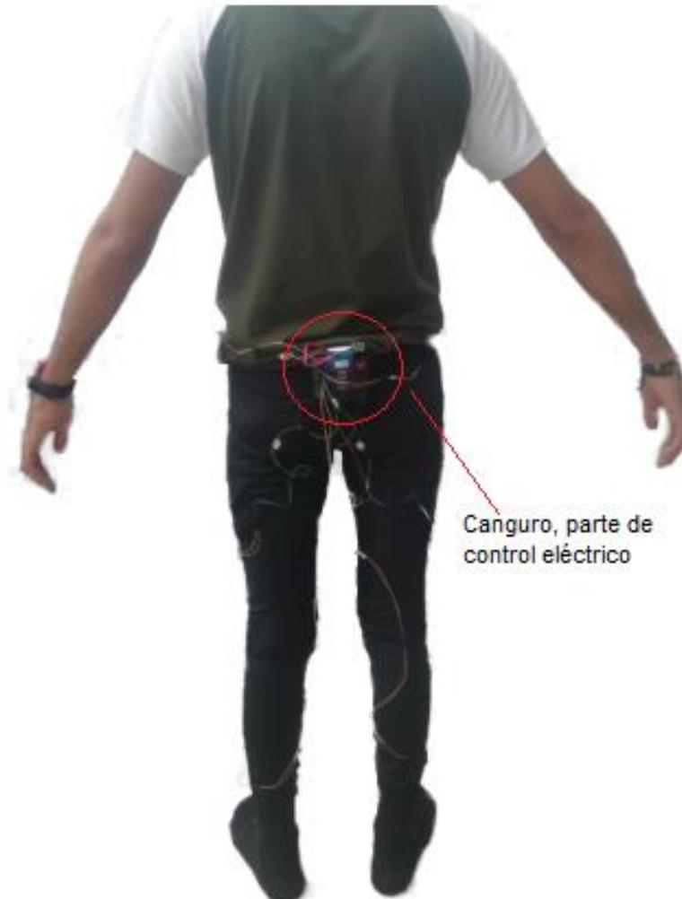
**Figura 3.26:** Vista trasera del traje con el canguro de control [Autor].
