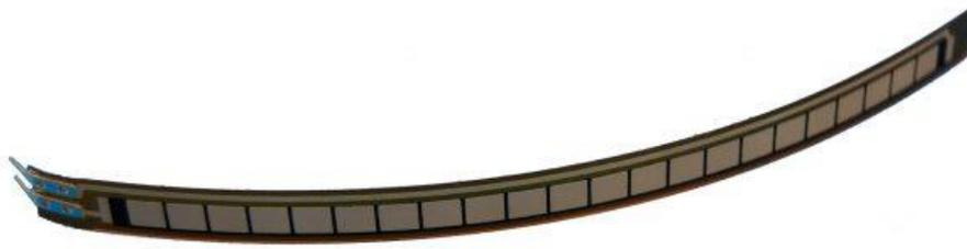
**Figura 2.6:** Sensores flexibles resistivos. [15]
