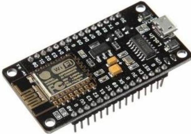
**Figura 2.12:** NODEMCU LUA WiFi basado en ESP8266 [21].
