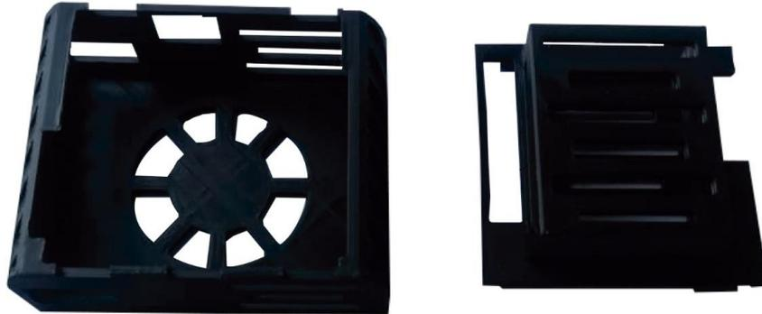
**Figura 3.23:** Chasis del prototipo impreso en 3D [Autor].
