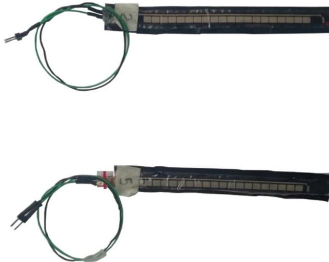
**Figura 3.2:** adaptación de Sensor Flex hacia traje [Autor].
