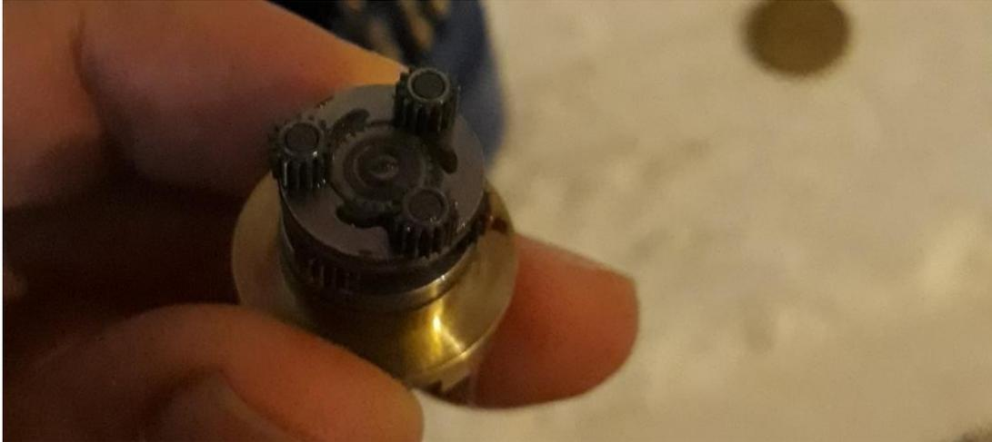
*Figure 49. Engranés de la transmisión planetaria de la caja reductora.*
