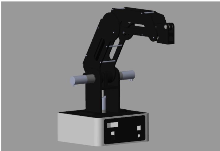
Figure 89. Posición del efector final del robot en Simscape, mediante el movimiento simultáneo de ejes ( $q1=\pi$ ,  $q2=\pi/3$ , y  $q3=-\pi/3$ ).
