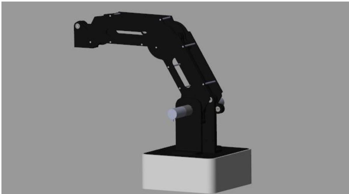
Figure 95. Posición del efector final del robot en Simscape, mediante el movimiento coordinado ( $q_1=\pi$ ,  $q_2=\pi/3$ , y  $q_3=-\pi/3$ ).
