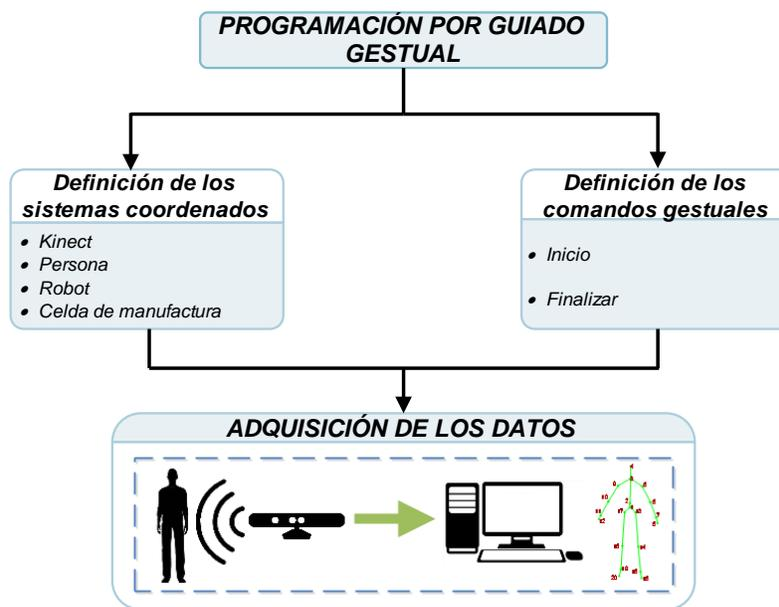
Figura 16. Diagrama de bloques de la captura del movimiento de un operador.
