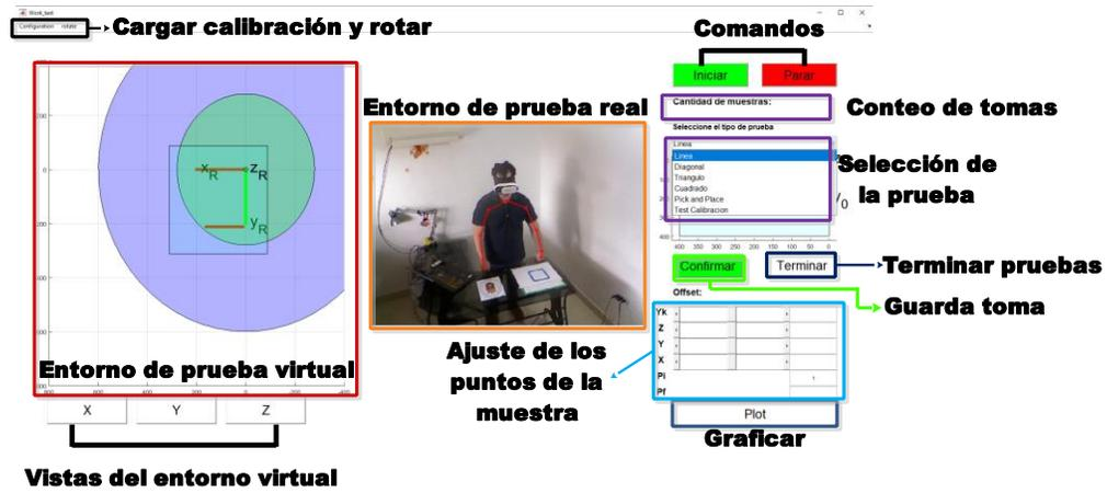
Figura 59. Plataforma de pruebas.
