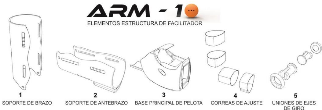
Ilustración 83 - Elementos estructura de facilitador
