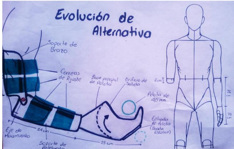
Ilustración 61 - Boceto de evolución de alternativa escogida, soportes con correas de ajuste, recolección por tensión y posicionamiento por flexión y extensión del brazo
