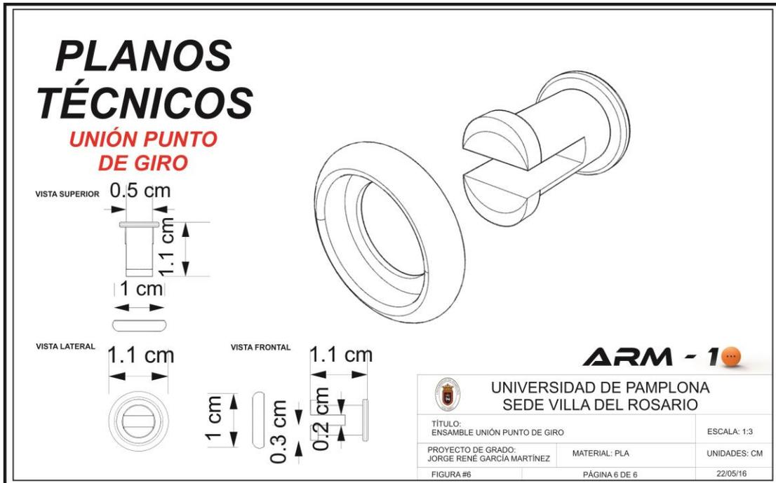
Ilustración 95 - Planos técnicos de mecanismo de unión en punto de giro
