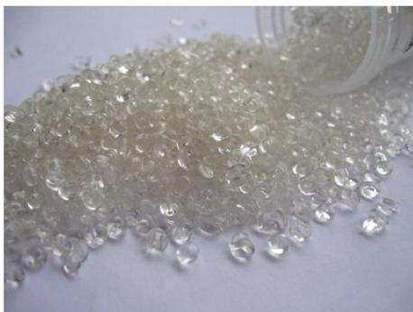
El PLA se puede formular para ser rígido o flexible y puede ser copolimerizado con otros materiales. El PLA se puede hacer con diversas características mecánicas dependiendo del proceso de fabricación seguido.
