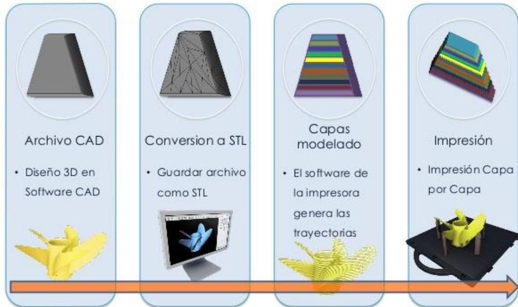
Ilustración 78 - Proceso de la impresión 3d
