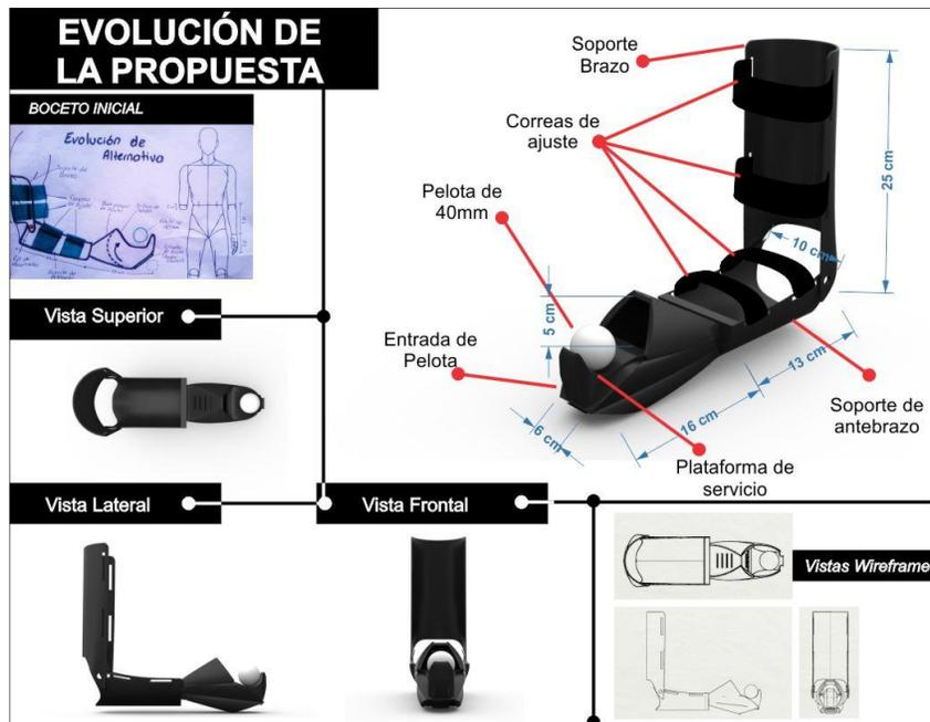
Ilustración 62 - Planos y especificaciones de modelado 3d de evolución de propuesta
