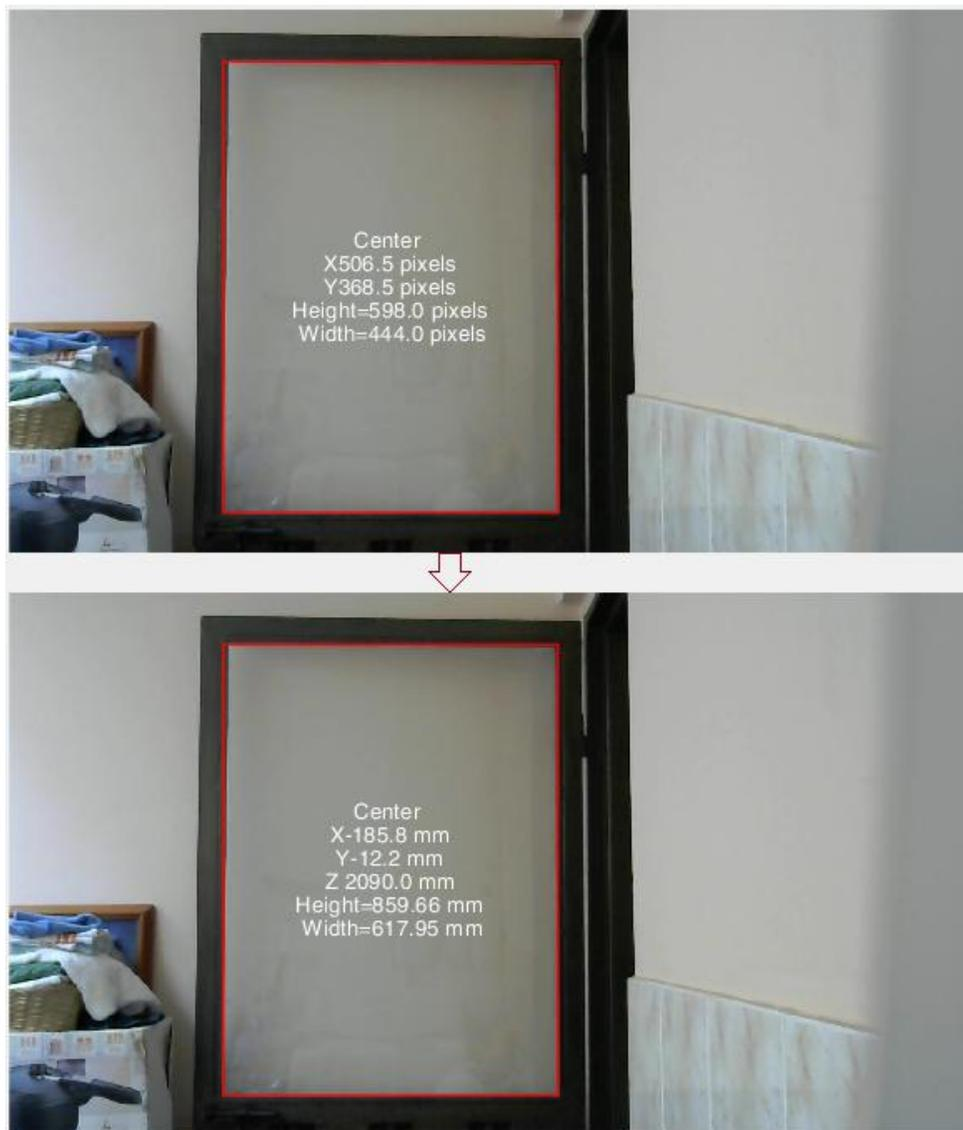
Figura 57. Prueba final para la conversión de pixeles a milímetros del vidrio segmentado.
