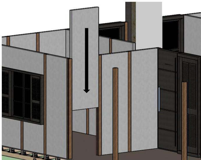
*Ilustración 30. Colocación de panel. Elaboración del autor*
