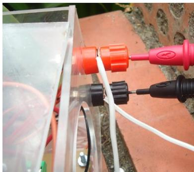
Figura 57: medida de voltaje al entra del inversor. Fuente: El Autor
