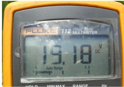
Figura 58: voltaje medido del panel. Fuente: El Autor
