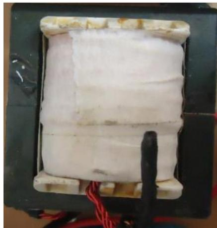
Figura 24: transformador de ferrita utilizado. Fuente: del Autor
