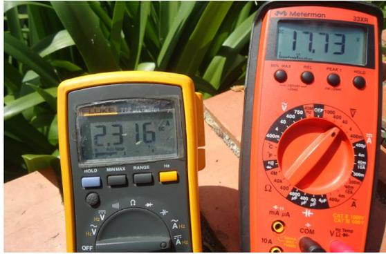
Figura 63: corriente entregada por convertidor. Fuente: El Autor
