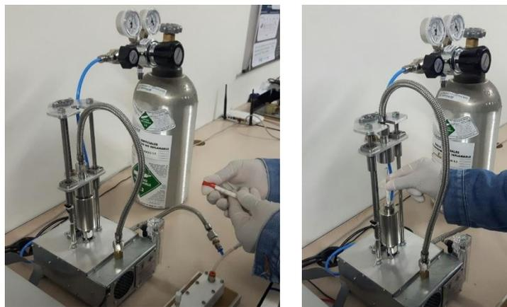
**Figura 85.** Inserción del tubo en la capsula de calentamiento.
