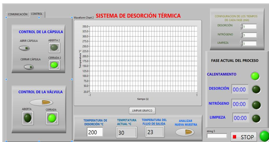
**Figura 56.** Interfaz gráfica para el control del sistema de desorción térmica.
