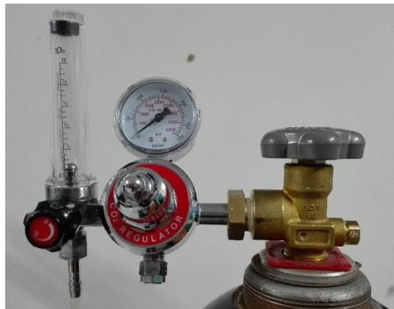
**Figura 31.** Sistema de limpieza de la cámara de medida.
