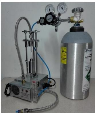
**Figura 55.** Sistema de desorción térmica acoplado al cilindro de nitrógeno.
