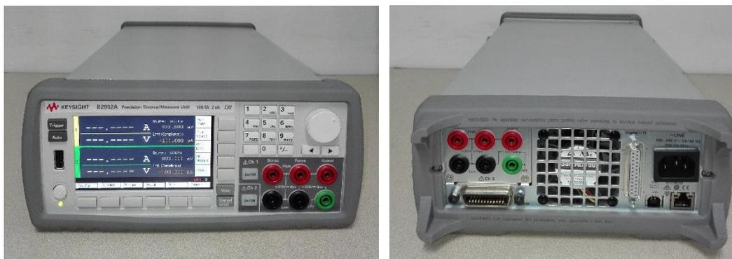
**Figura 32.** Fuente de precisión B2902A KEYSIGHT.
