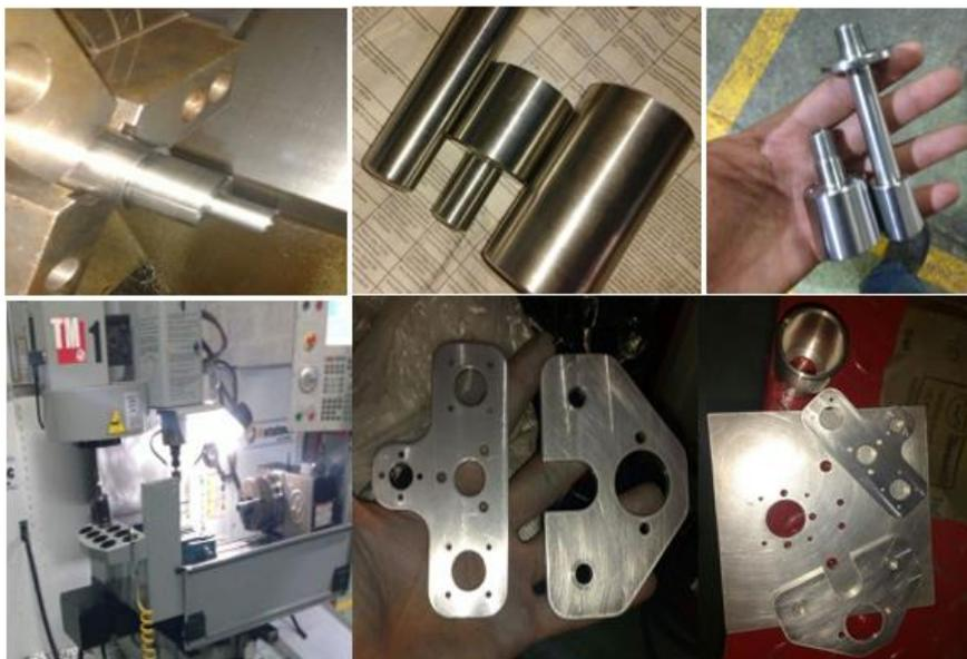
**Figura 50.** Mecanizado de las piezas del sistema de desorción térmica.
