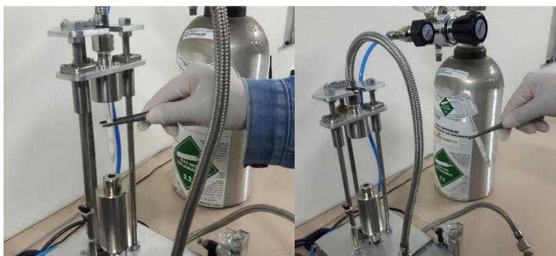
**Figura 87.** Manera correcta de retirar el tubo Tenax con pinza.
