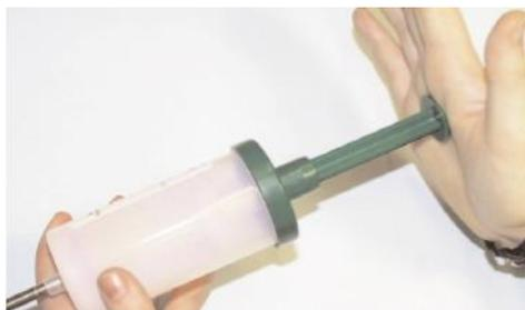
**Figura 7.** Conexión del émbolo
