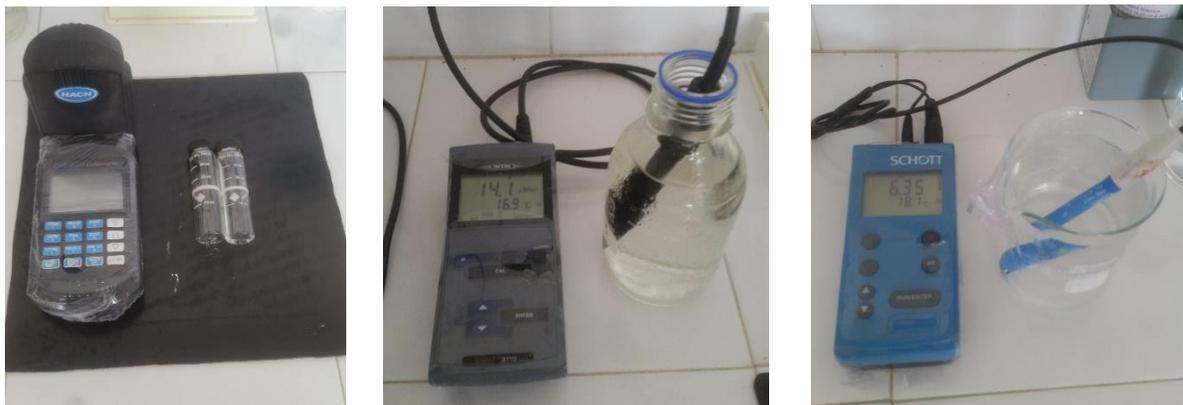
**Imagen 16.** Colorímetro, Conductímetro y pH-metro
