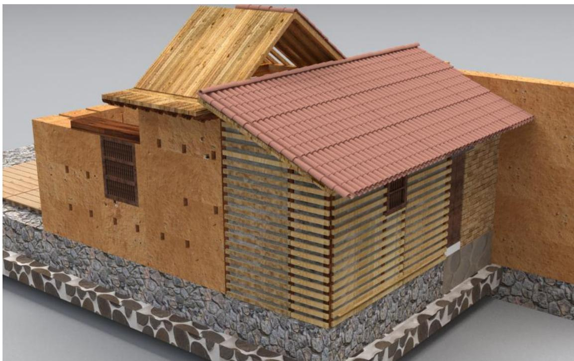
Imagen No. 72. Detalle de las uniones de diferentes sistemas constructivos (tapia pisada y bahareque). Fuente: Elaboración propia 2017
