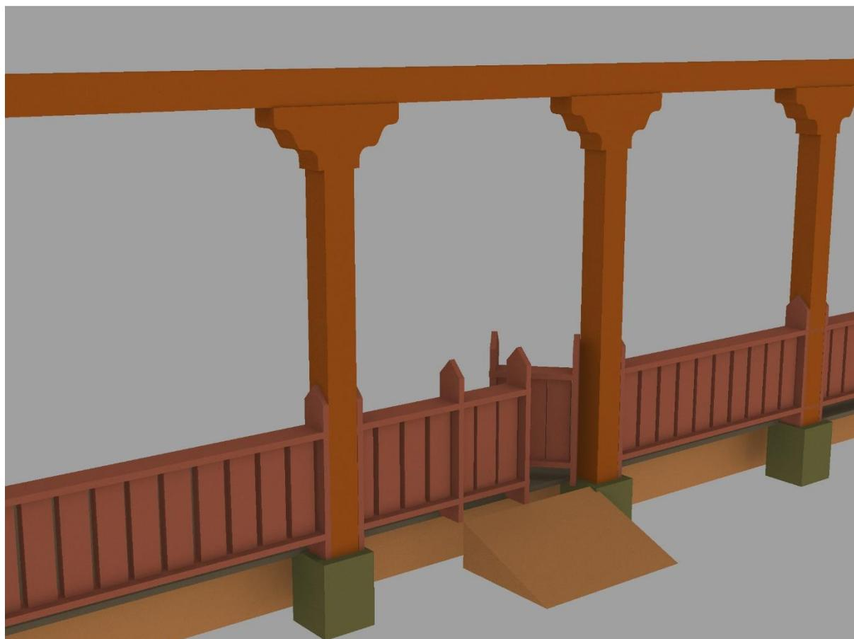
Imagen No. 80. Detalle del barandal y pilares elementos constructivo del corredor. Fuente: Elaboración propia, 2017 (material en proceso)
