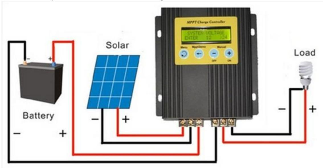
Ilustración 8: Conexión de panel solar
