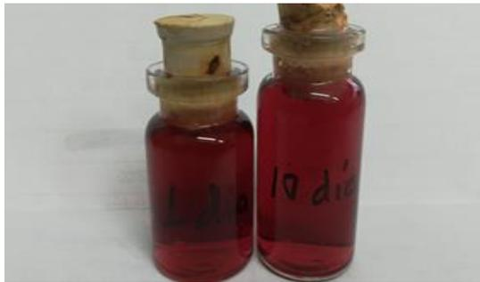
Figura 14. Nanopartículas sintetizadas y almacenadas por 10 días a temperatura ambiente
