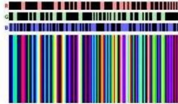
FIGURA 12. Ejemplo de indexación en franjas de color basada en la secuencia De bruijn. Tomada de [33]
