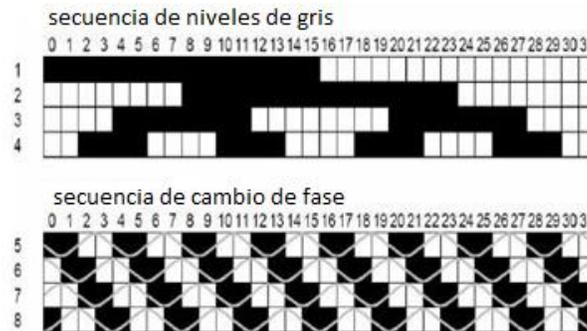
FIGURA 5. Combinación código gris con phase shifting. Tomada de [5]
