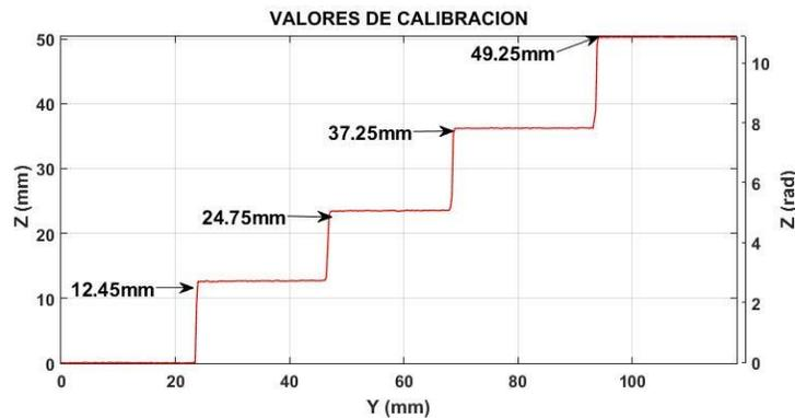
FIGURA 30. Perfil topográfico de los escalones con sus respectivas relaciones de fase a alturas de cada peldaño
