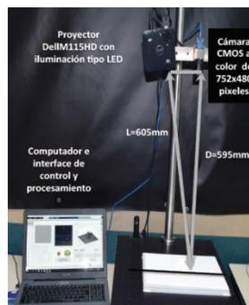
FIGURA 26. Imagen del montaje óptico para el registro de información 3D usando la técnica de proyección de franjas
