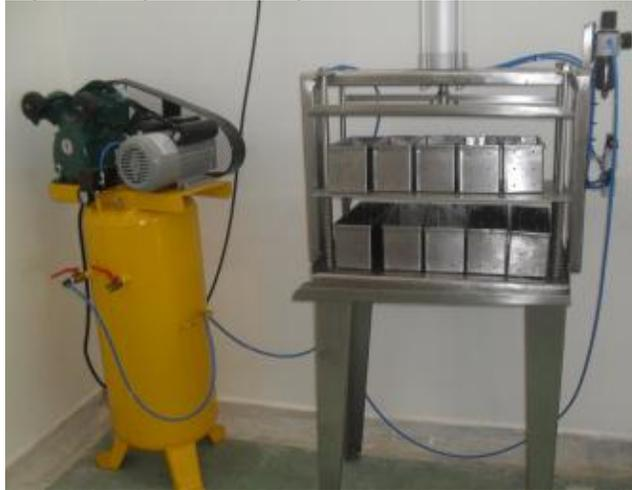
Figura 40. Prensa neumática para queso
