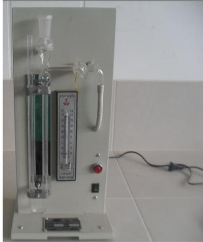
Figura 45. Equipo de permeabilmetro de blaine
