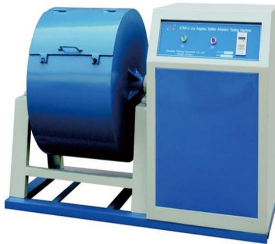
Figura 54. Los ángeles máquina de ensayo de abrasión
