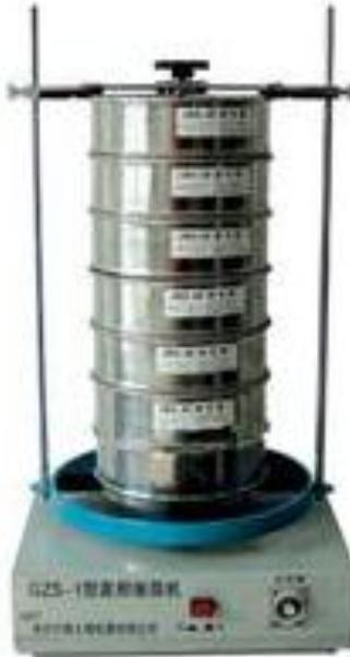
Figura 59. Tamizadora de alta frecuencia
