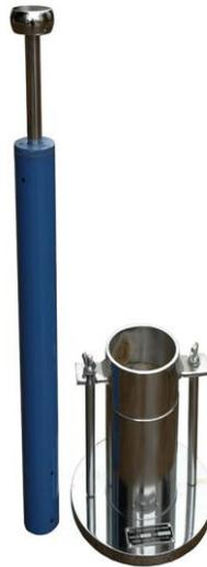
Figura 47. Compactador de luz portátil
