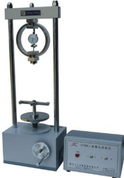
Figura 46. Máquina de pruebas CBR
