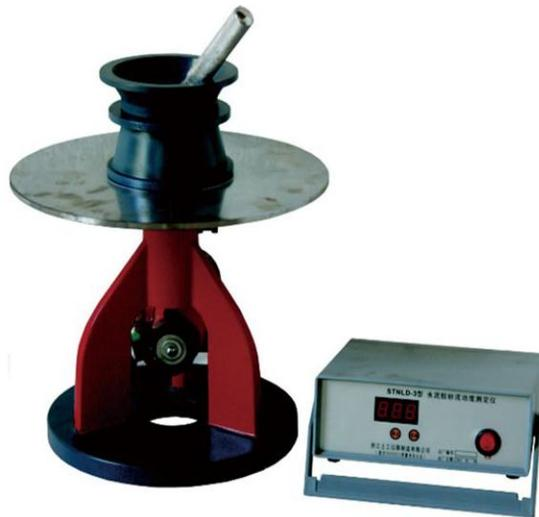
Figura 56. Mesa de mortero de cemento
