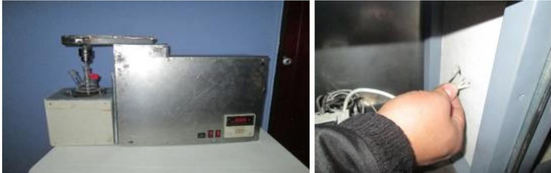
*Figura 53. Instalación y ajuste del reactor y conexión a la resistencia*
