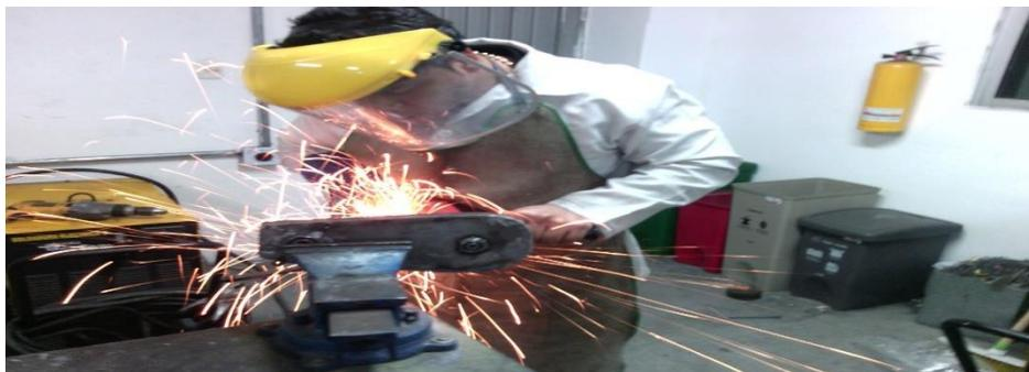
*Figura 46. Proceso de pulido de la caja del reductor de velocidad*
