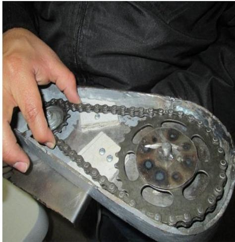
*Figura 51. Instalación y ajuste del reductor de velocidad*
