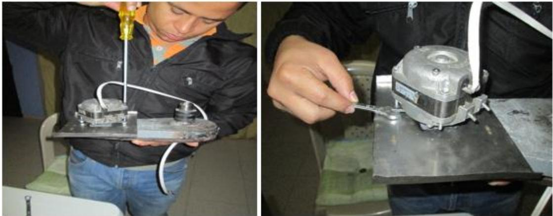
*Figura 50. Instalación y ajustes del motor*
