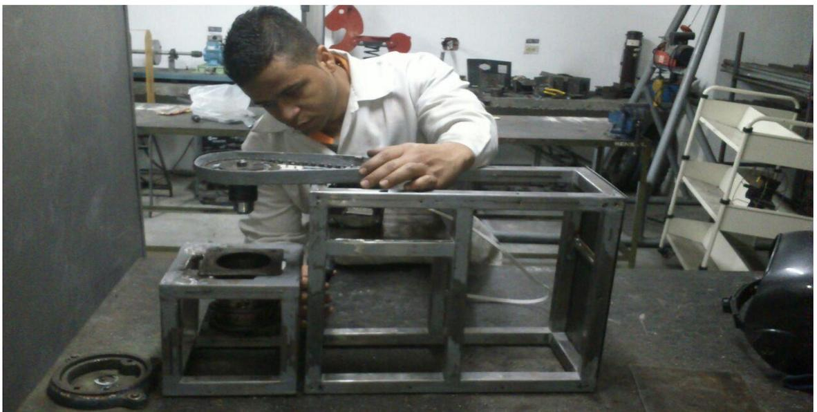
*Figura 48. Alineación del reductor de velocidad con el reactor*
