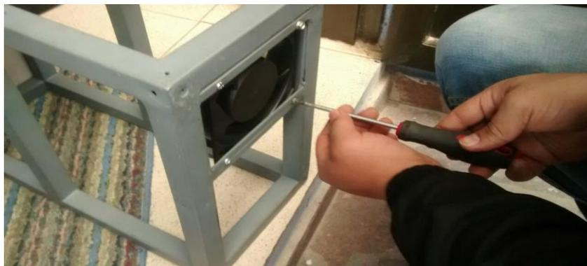
*Figura 52. Instalación del ventilador*
