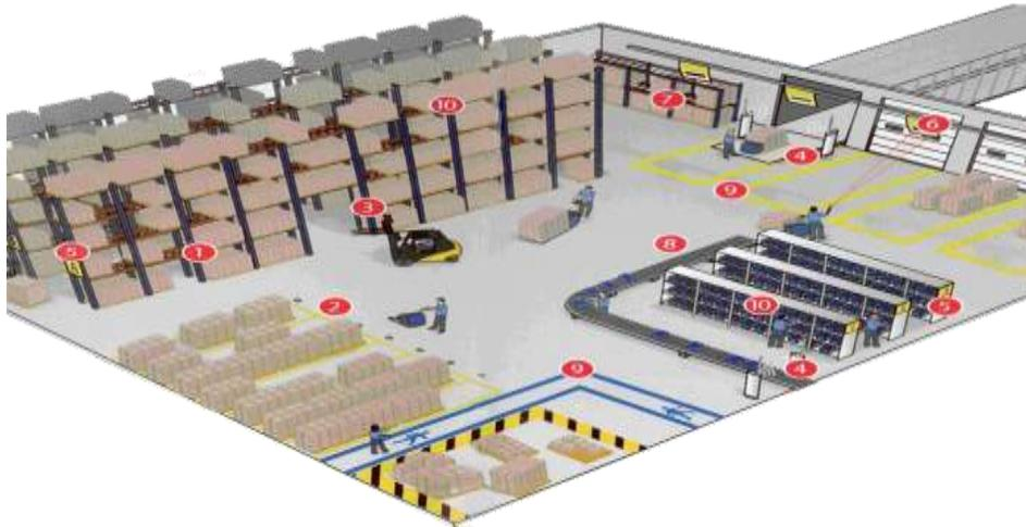
Figura 26. Ubicación de productos en el almacén, 1. Banda inoCode, 2. Sistema Floortag. Etiquetas suelo, 3. Etiquetas Tarjetas de puentes ,4. Etiquetas RFID, 5. Etiquetas Paneles de pasillo, 6. Etiquetas Larga Distancia, 7. Etiquetas Magnéticas, 8. Etiquetas cajas de plástico, 9. Etiquetas Pintura al suelo, 10. Etiquetas unitarias, tomado de (Integración y Desarrollo de Aplicaciones. S.L, 2014)
