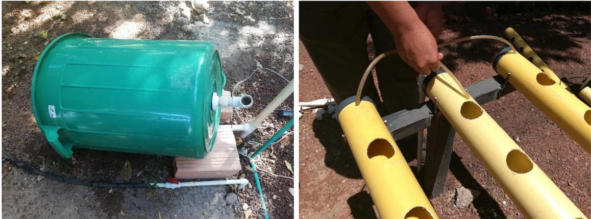
**Grafico N° 18.** Conexión al biofiltro y reducción para conexión a tuberías. Fuente personal.
