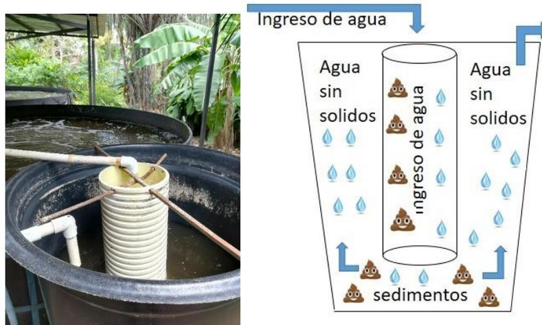
**Grafico N° 13.**Funcionamiento de sedimentador. Fuente personal.
