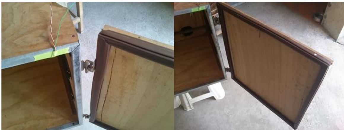
**Figura 65. Sistema de bisagra y sellado**
