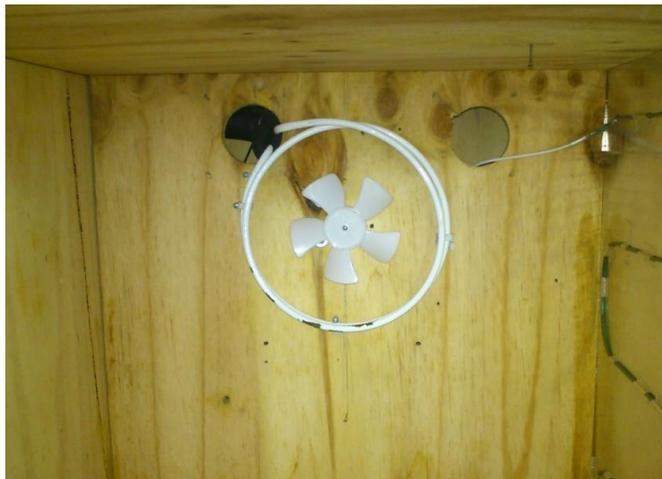
**Figura 69. Sistema de recirculación del aire frío**
