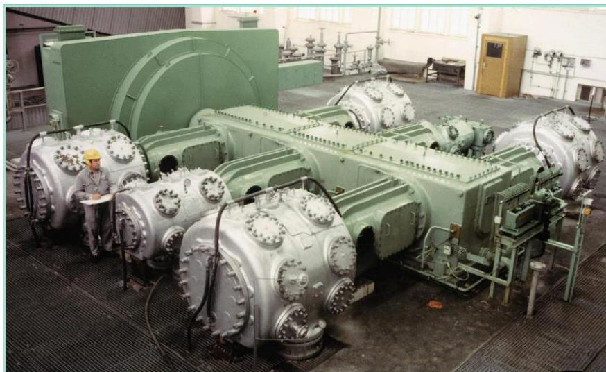
Figura 14. Compresores Recíprocos.
