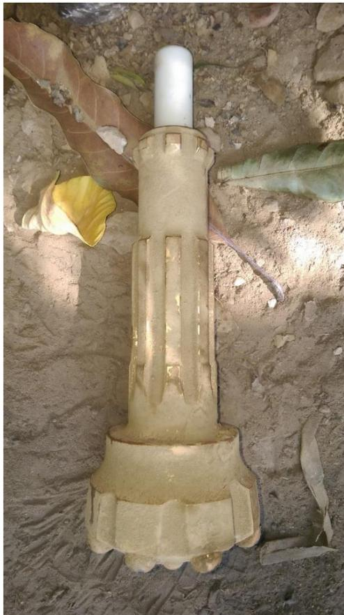
**Fotografía 37.** Detalle dientes de la broca de perforación. **Fuente:** Autor
