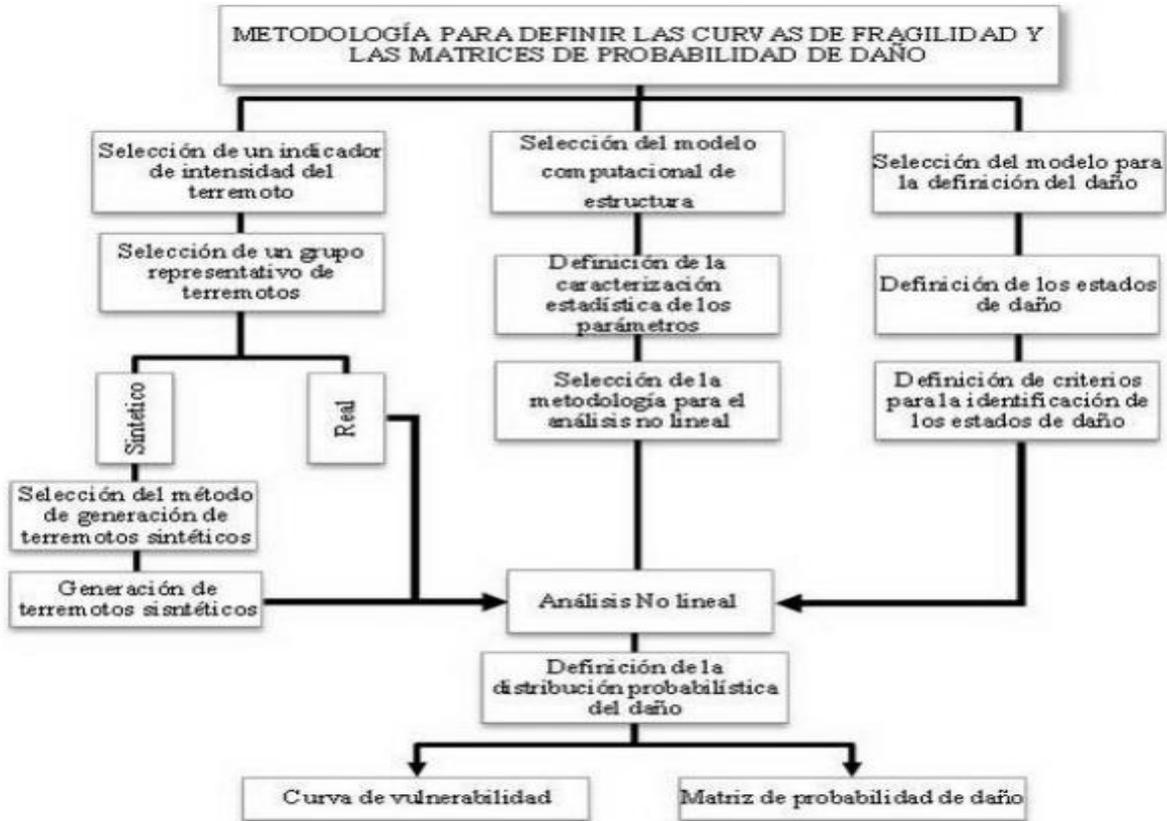
Componentes del cálculo de las curvas de fragilidad y matrices de probabilidad de daño con métodos analíticos, (Dumova-Jovanoska 2004).
