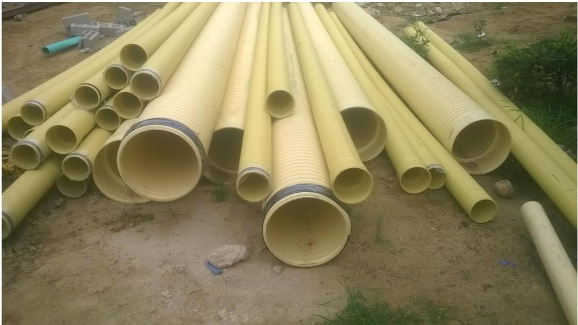
Ilustración 9. Tubería PVC lisa y tipo fort de 6" y 16". Fuente: Autor.
