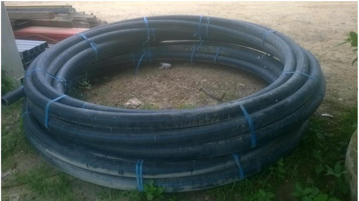
Ilustración 8. Tubería PEAD 90 mm. Fuente: Autor.
