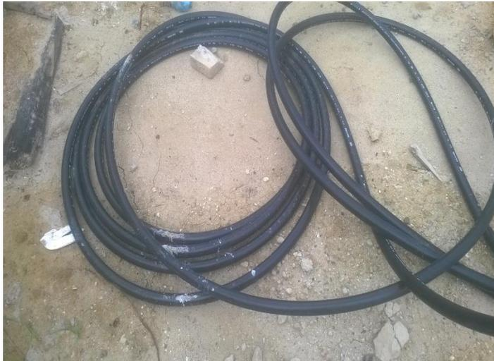
Ilustración 24. Tubería PEAD 32mm. Fuente: Autor.
