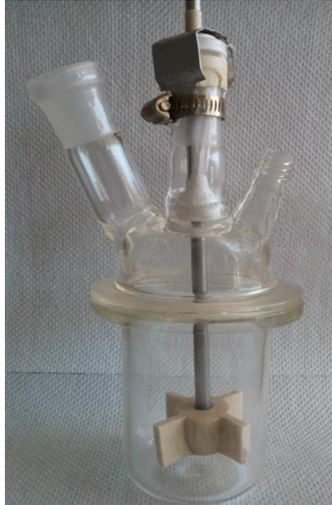
**Ilustración 4.** Reactor de pruebas en vidrio borosilicato, con agitador.
