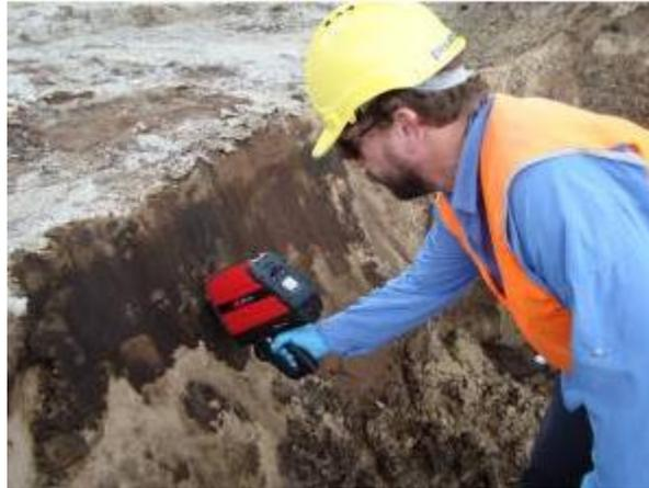
*Figura 1.* Espectrómetro infrarrojo utilizado en Australia. (Equipos y Laboratorio de Colombia S.A.S. (2015)).
