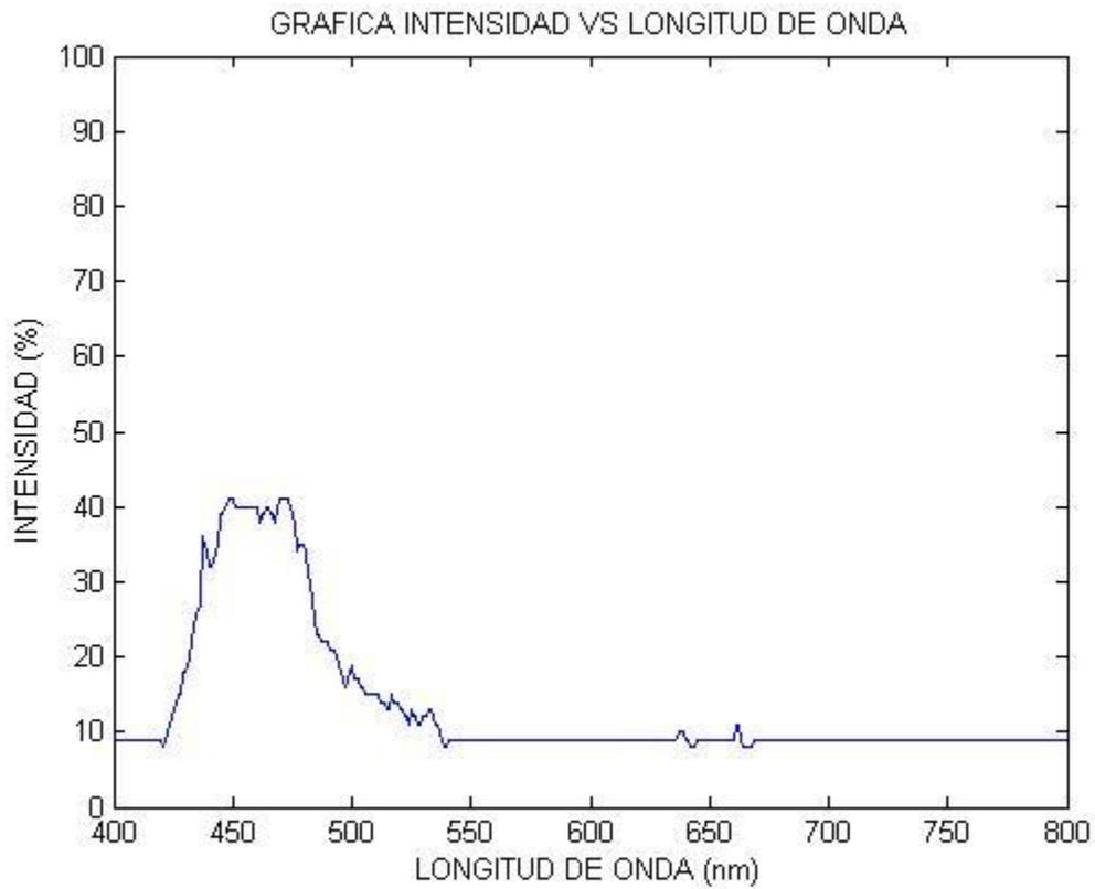
Anexo 213. Gráfica de Intensidad vs Longitud de onda para la prueba 38f.
