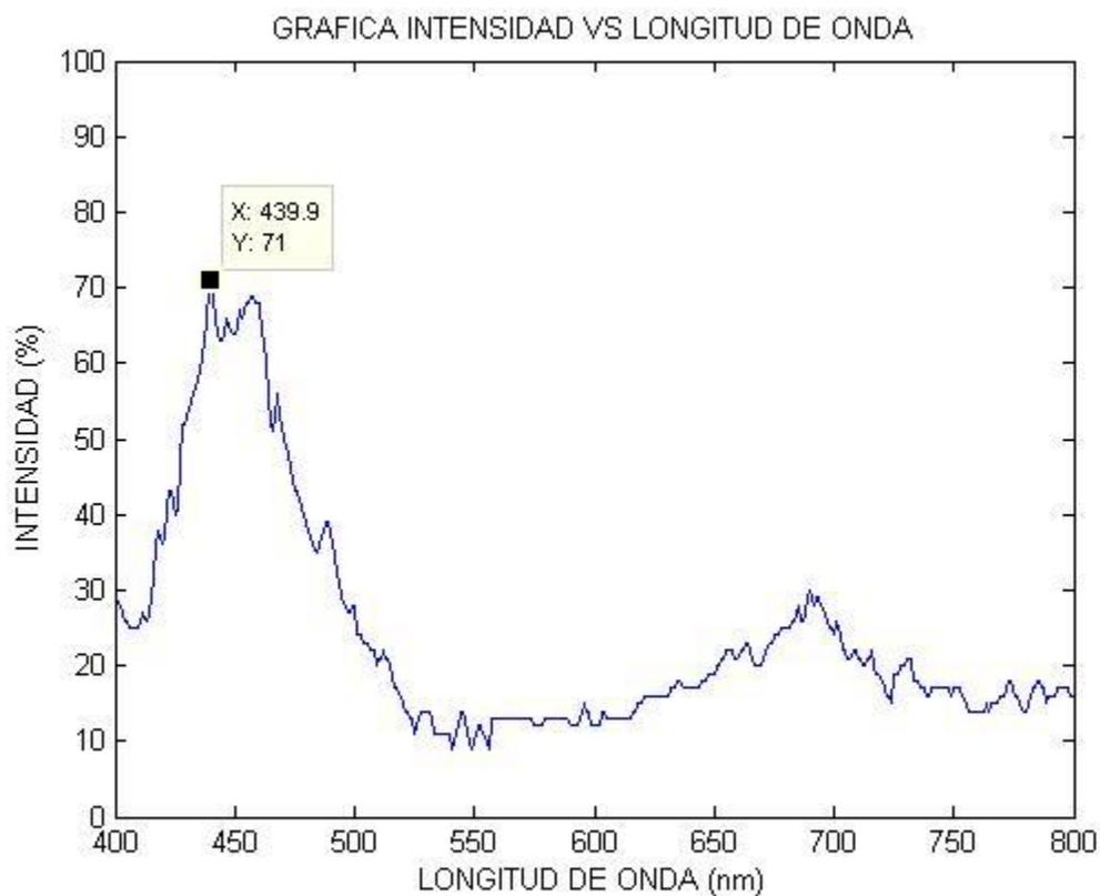
Figura 16. Gráfica Intensidad vs Longitud de onda para la muestra de grado 7.
