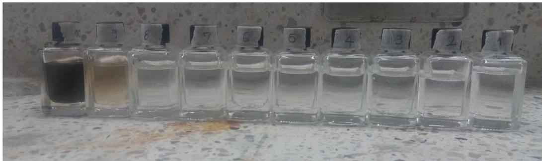
*Figura 10.* Muestras para la curva de calibración.
