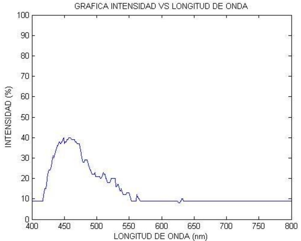
Figura 74. Gráfica de Intensidad vs Longitud de onda para una muestra de suelo contaminado.
