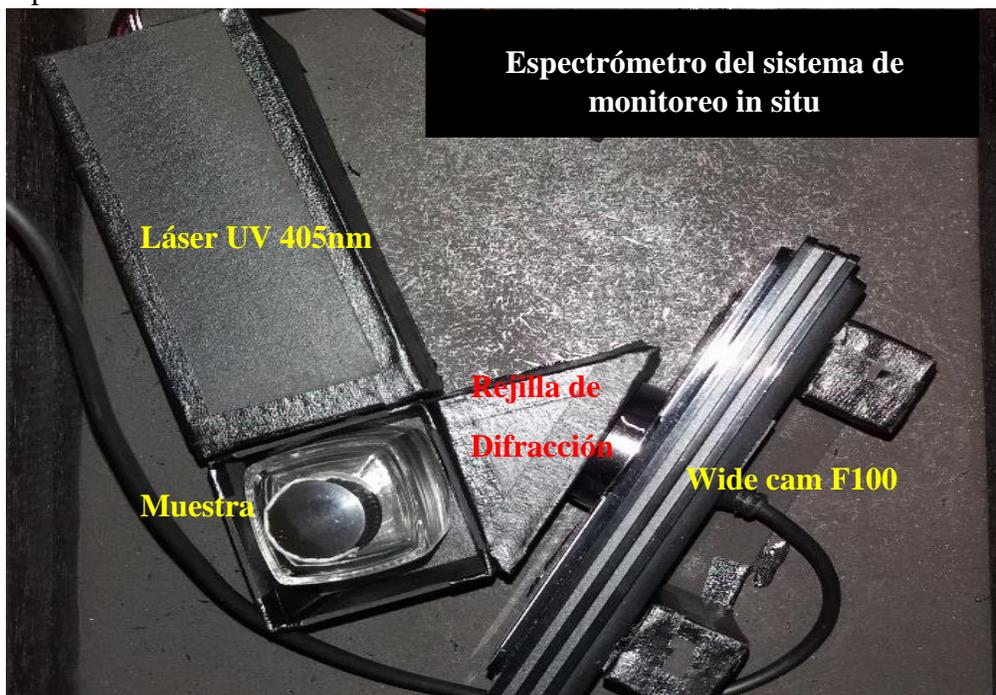
Figura 5. Montaje final del espectrómetro.
