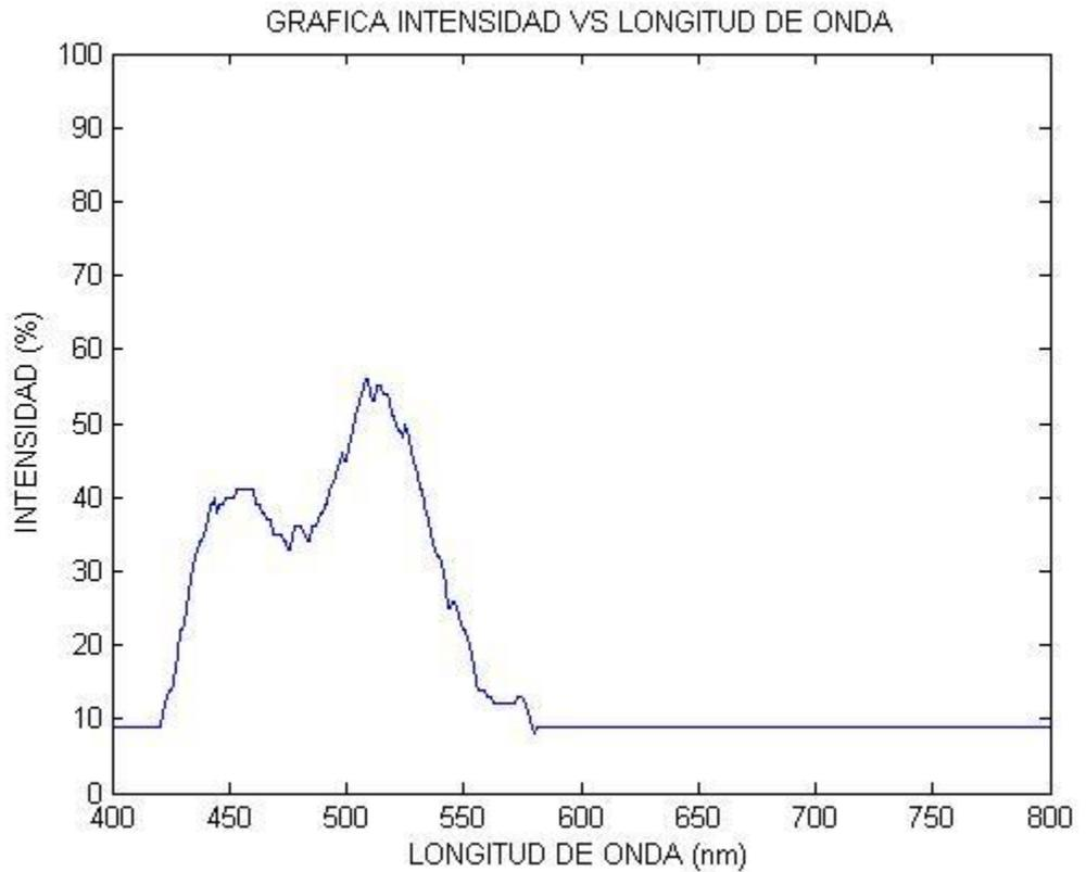
Figura 76. Gráfica de Intensidad vs Longitud de onda para una muestra con una gota de aceite lubricante usado.
