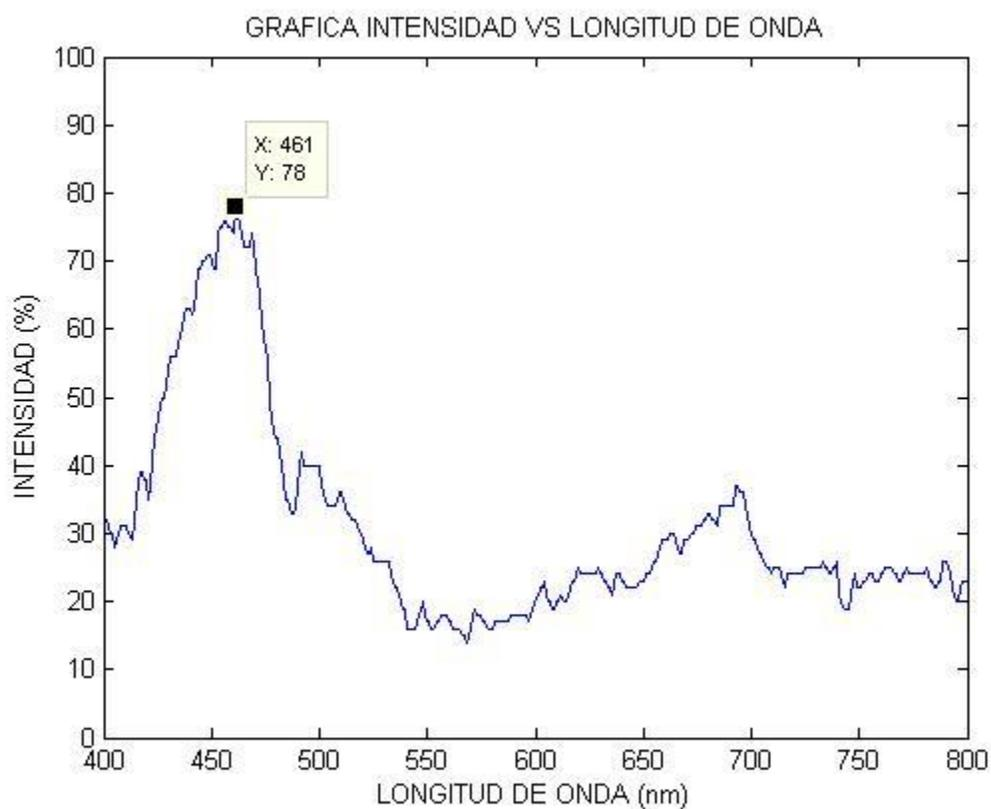
Figura 14. Gráfica Intensidad vs Longitud de onda para la muestra de grado 8.
