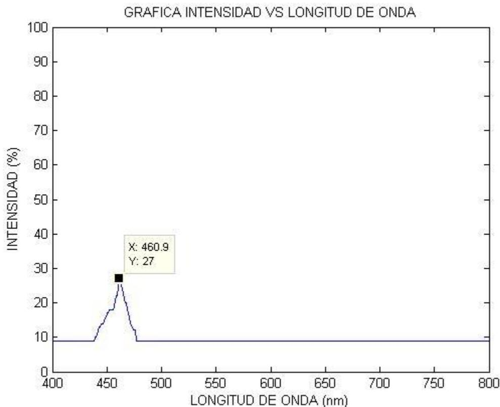
Figura 28. Gráfica Intensidad vs Longitud de onda para la muestra de grado 1.
