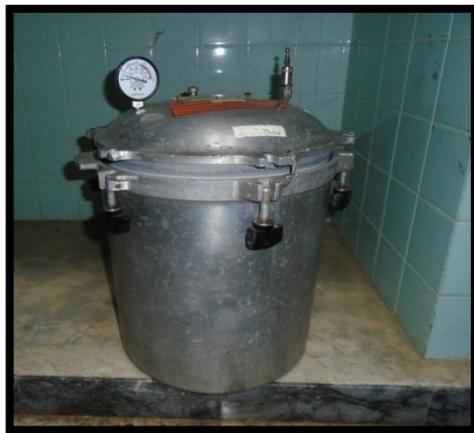
Fotografía 52: Olla que se utiliza para la esterilización.
