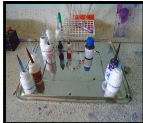
Fotografía 47: Colorantes y reactivos evacuados al desagüe sin desactivación previa.
