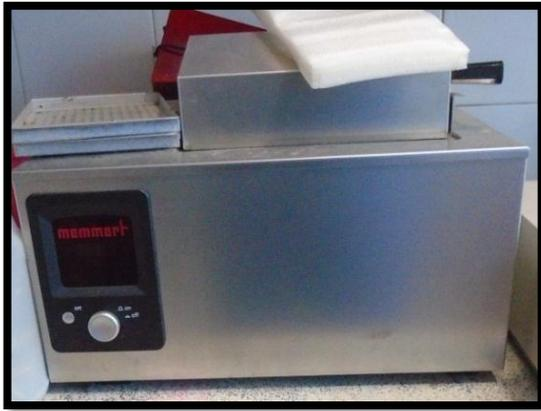
Fotografía 85: Horno para el secado del material de vidrio reutilizable en laboratorio clínico.
