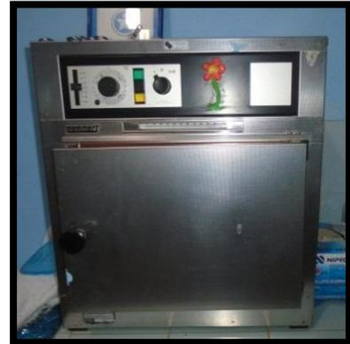
Fotografía 9: Horno de secado para el instrumental de laboratorio clínico.
