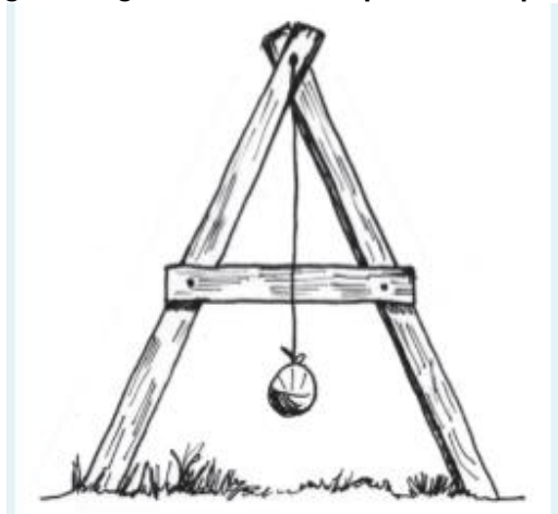
Imagen 8. Agronivel utilizado para medir pendiente
