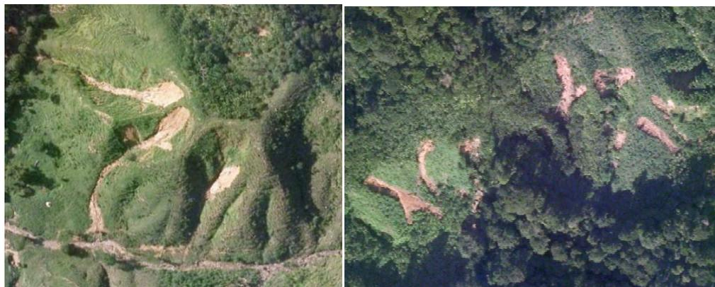
Figura 38. Enjambre de deslizamientos sobre laderas deforestadas
