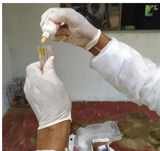
Figura 21. Toma y Ensayo del cloro Residual
