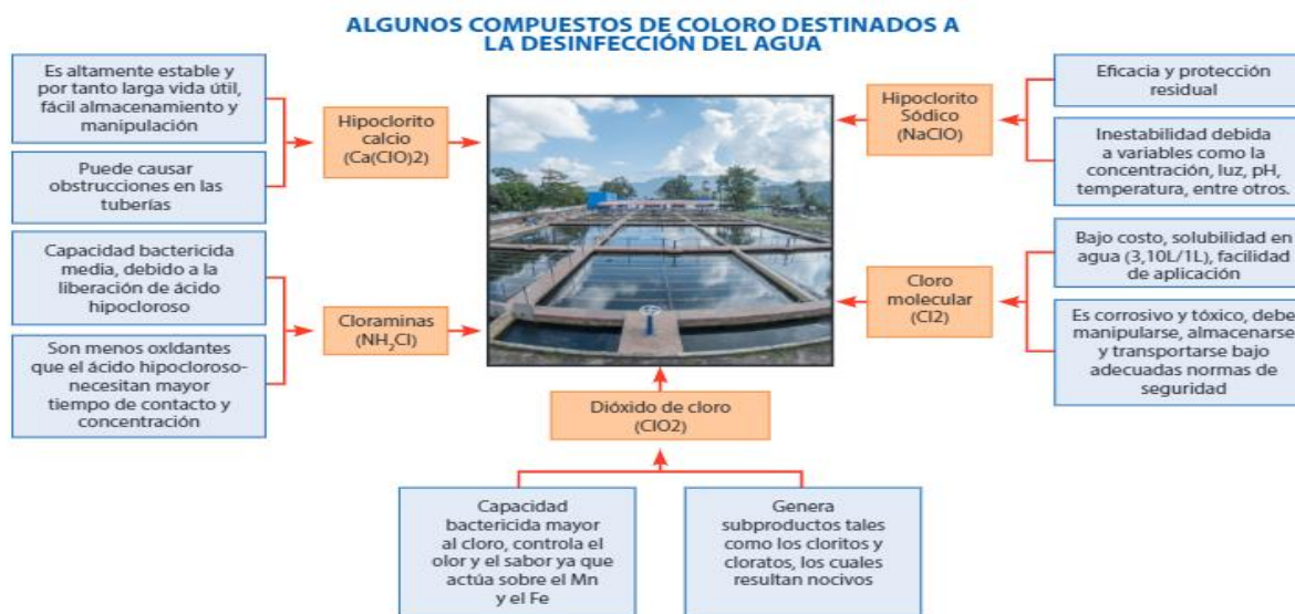
Figura 3. Algunos compuestos de cloro utilizados en la desinfección del agua.
