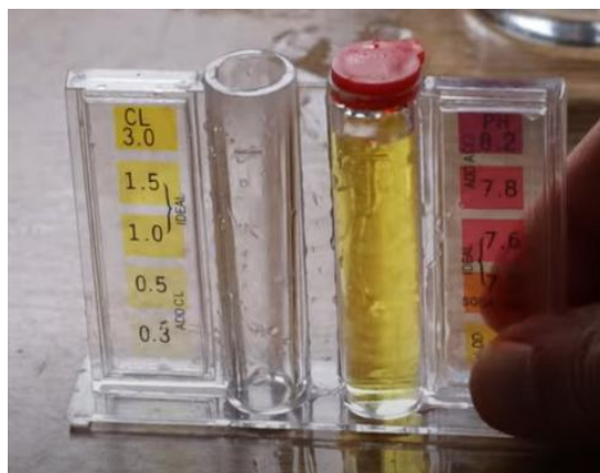
Figura 17. Toma de Muestra del pH
