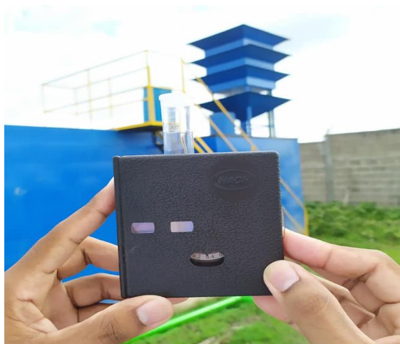
Figura 22. Análisis de la muestra del cloro Residual
