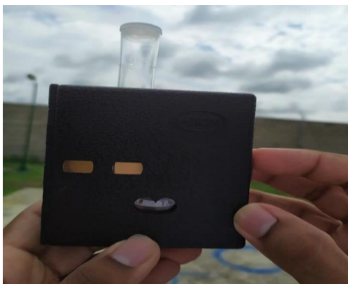
Figura 18. Toma de muestra del pH.
