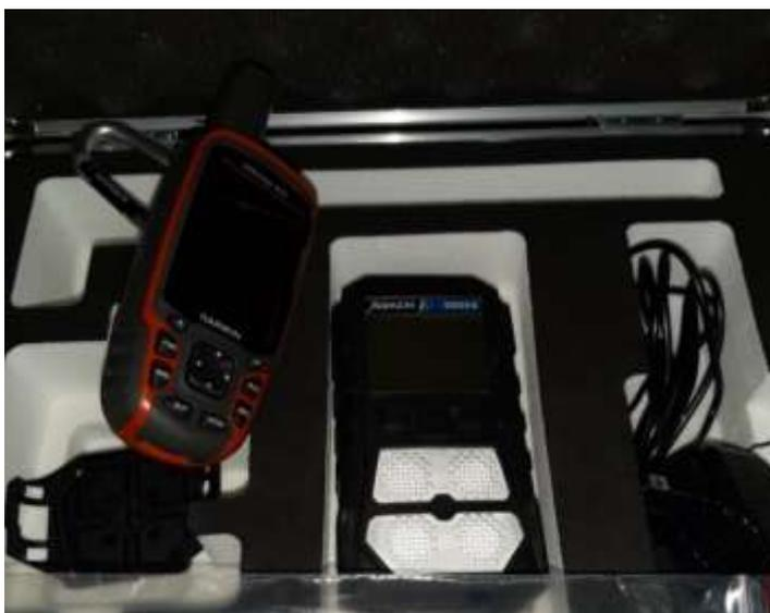
*Figura 8. Detector de gas Hawest y GPSmap. Fuente: Peralta, I. 2021.*
