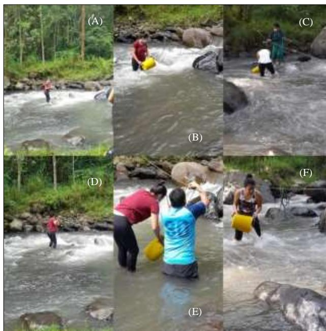
*Nota: (A) Medición ancho del río, (B) Método volumétrico para caudales en punto 2 de muestreo, (C) Método volumétrico para caudales en punto 1 de muestreo, (D) ubicación de una cuerda para tener un soporte para medir el ancho del cauce, (E) Sujetando el valde a la cuerda de soporte, (F) Método volumétrico para caudales en punto 3 de muestreo.*
