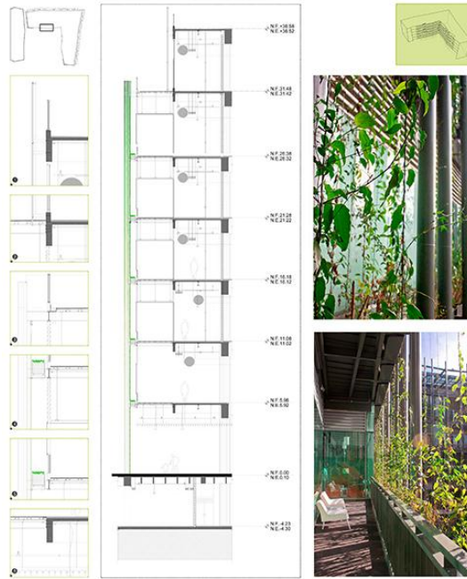
Figura 24. Detalle fachada verde
