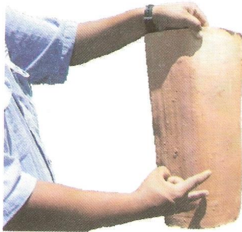
Gráfico 206: Comprobación de la calidad de la Teja de Barro por medio del sonido. Fuente: Arquitectura de tierra, sustentabilidad y cultura. Noviembre 2016.
