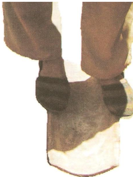
Gráfico 207: Comprobación de la calidad de la Teja de Barro por medio de carga. Fuente: Arquitectura de tierra, sustentabilidad y cultura. Noviembre 2016.
