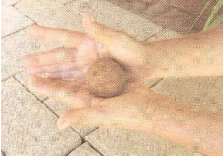
Gráfico 168: Ensayo mediante bolas de tierra.
