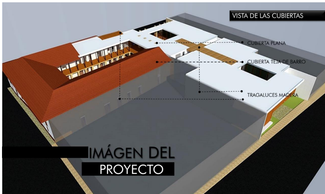
Gráfico 234: Imagen del Proyecto, Vista de las Cubiertas. Fuente: Autor. Noviembre 2016.
