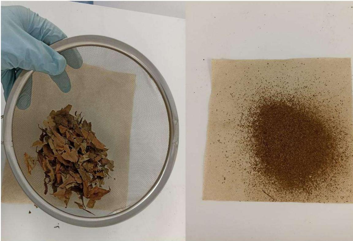
**Figura 10:** Procedimiento de tamizado en hojas de coca. (fuente propia)
