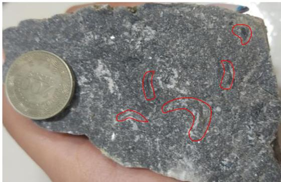
Figura 20. Caliza tipo Wackstone con cristalización de fósiles en esparita.
