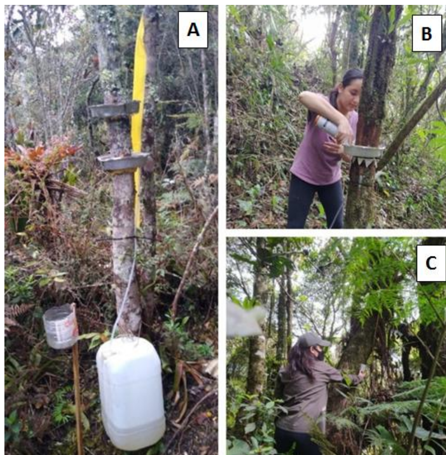
Figura 4. (A) Instalación de collarines y pluviómetros para la medición de las variables escorrentía cortical y precipitación en interna en Schefflera cuatrecasiana , (B) Resellado de los collarines en Cyathea cf. andina ., (C) Instalación de multiparametro. Fuente: Fotos tomadas por: Andrés F., 2020
