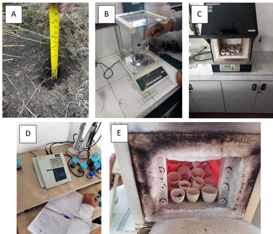
Figura 3. Tratamiento de las muestras edáficas. A) Muestreo a 10 cm. B) Peso de suelo. C) Secado a 105°C x 24h. D) Medición de pH. E) Calcinación a 550°C x 40 min.
