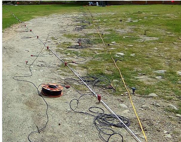
Imagen 19. Tendido sísmico con el GEODE.
