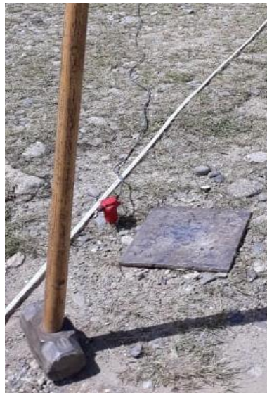
Imagen 9. Martillo y platina utilizados en la investigación.
