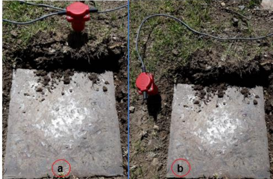
Imagen 15. Trigger en una posición (a) por encima del nivel de la platina (b) al nivel de la platina.
