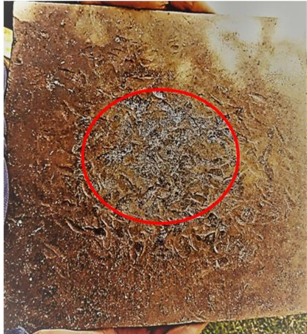
Imagen 16. Muecas en la platina debido a los golpes del partillo.
