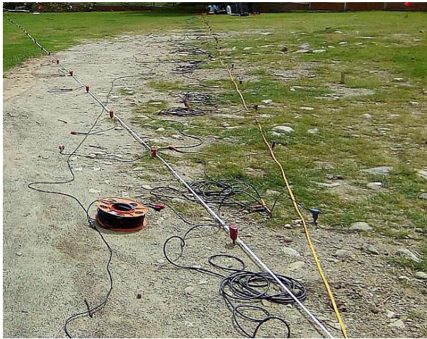
Imagen 2. Adquisición con el equipo de sismica GEODE24.
