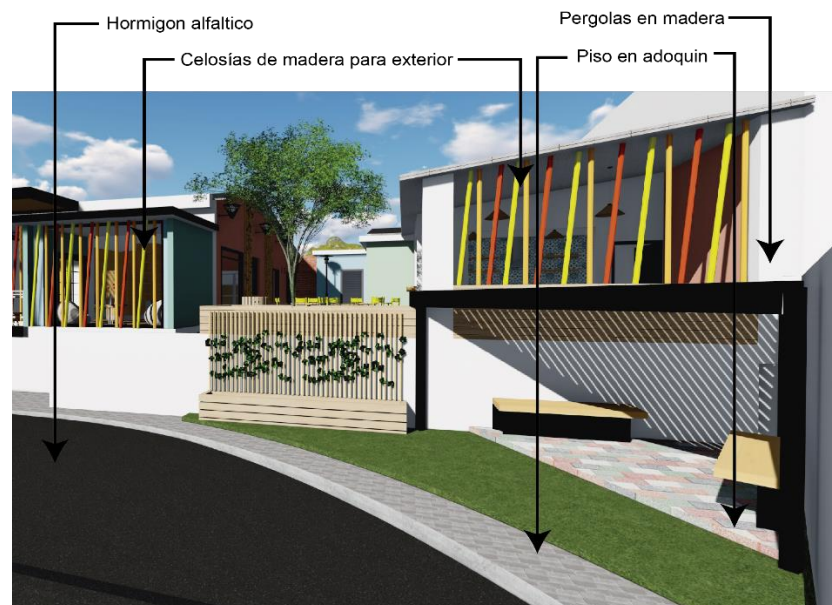
Ilustración 25: Materialidad de la fachada Fuente 8: Elaboración Propia
