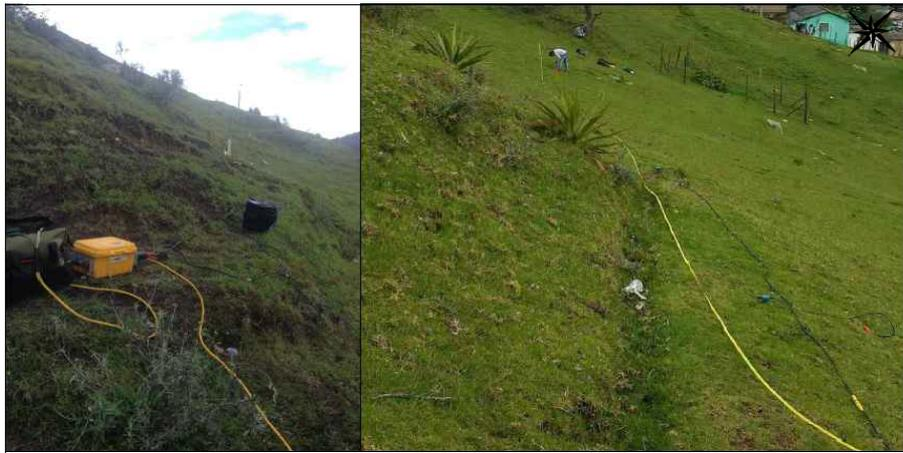
**Figura 4.** Fotografía de trabajo en campo a) Funcionamiento Geode ultra-lite de la empresa Geometrics b) Tendido de la línea sísmica en la zona de estudio Juan XXIII. Fuente: autores.
