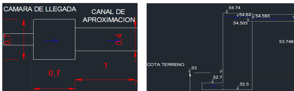
Ilustración 17. Plano captura en planta y perfil canal de aproximación a mezcla rápida.
