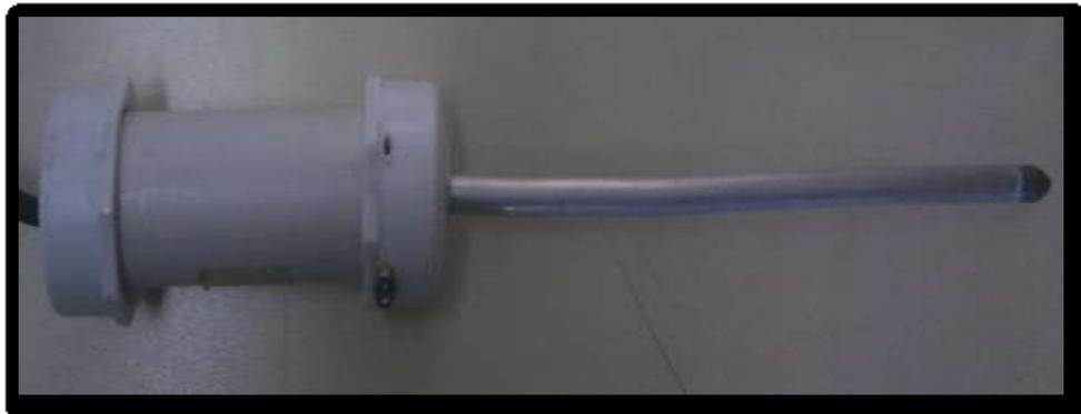
Figura 33. Diseño de la sonda de pH.
