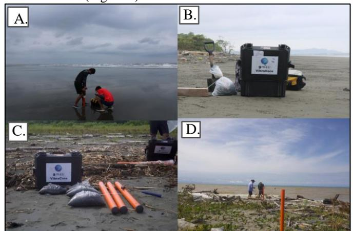
Figura 2. Fotografías del muestreo en las zonas de estudio. A. Toma de la muestra P03-P1, con el vibracore en la desembocadura del Río Patía en el margen Pacífico, colombiano. B. Equipo de muestreo en campo. C. Equipo de muestreo Gmas Lab, con muestras de Playa, marea y duna con su respectivo respaldo. D. Toma de muestra C07-P1, con vibracore en la desembocadura del río Sinú en el margen Caribe Colombiano. Fuente: El Autor
